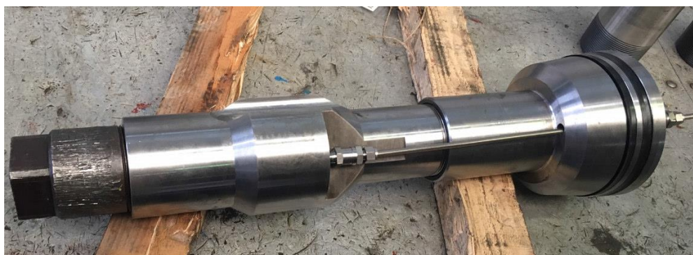
Slika 11-10. Modificirana konus glava (INA d.d. 2019)
