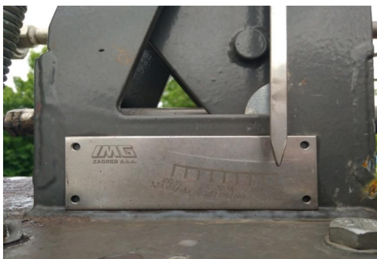
Slika 10-3. Skala dužine hoda klipa pumpe i pripadajući volumen utiskivanja
