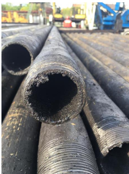
Slika 8-2. Parafinski talog na unutarnjoj stijenci tubinga
