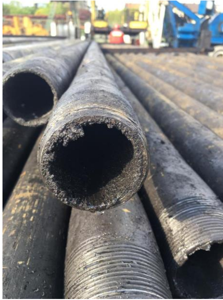
Slika 8-2. Parafinski talog na unutarnjoj stijenci tubinga
