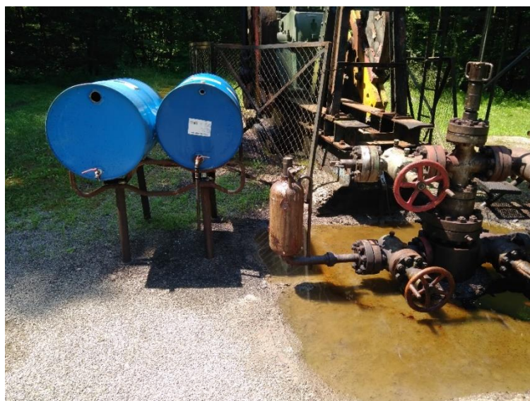
Slika 8-3. Shema njihalice i sustava sa bocom za povremeno doziranje aditiva (INA d.d., 2018)
