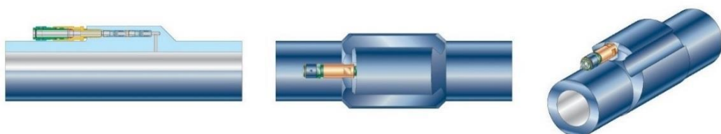
Slika 11-9. Bočno vreteno sa injektorom za utiskivanje kemikalija (Stipanicev et al., 2017)
