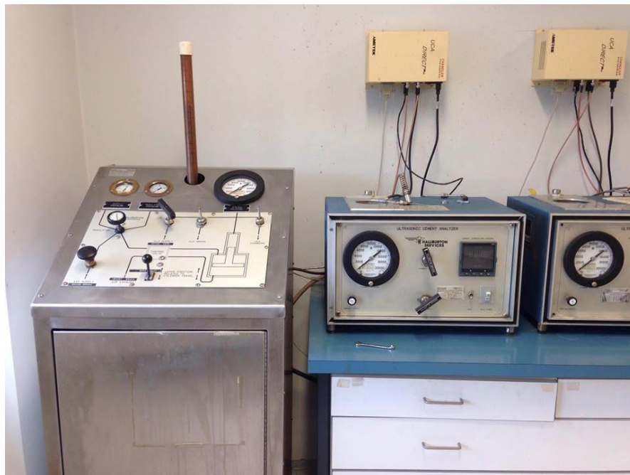
Slika 5-10. Ultrazvučni analizator (UCA) (Šeb, 2018)
