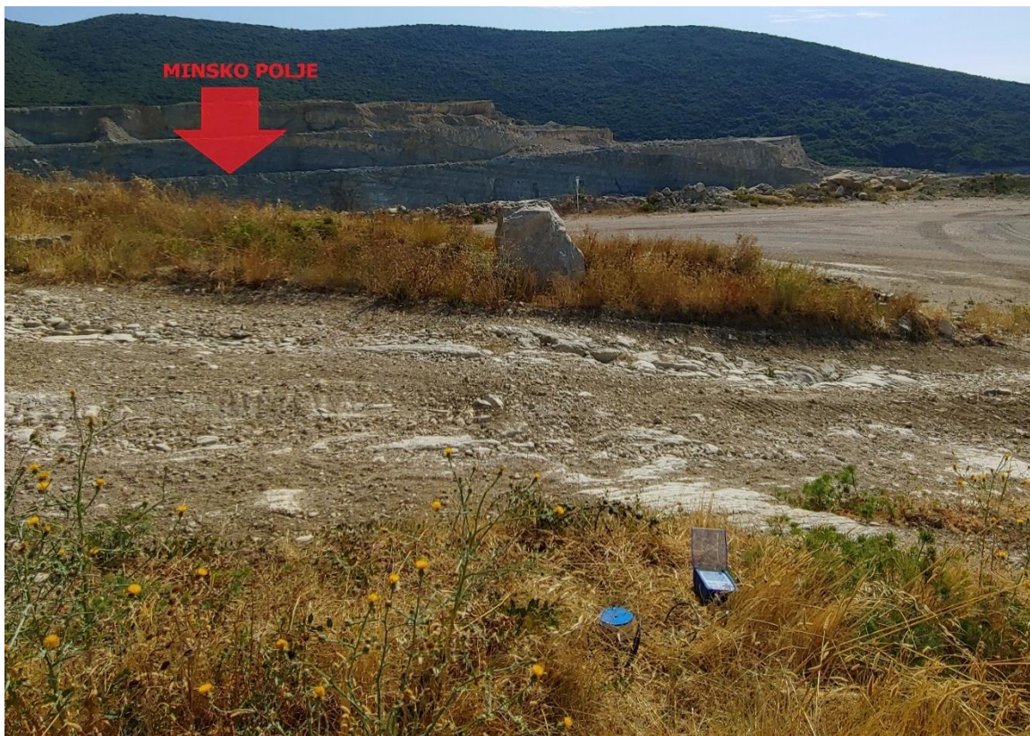
Slika 7-4 Postavljeni geofon na mjestu opažanja broj 2
