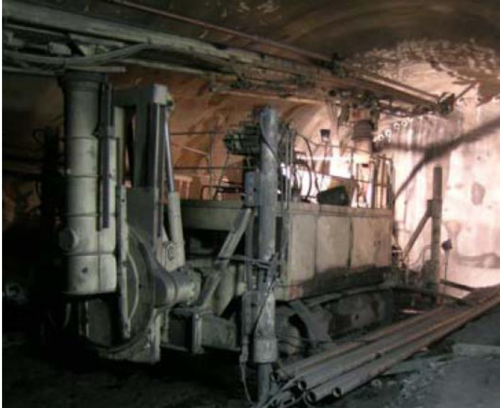
Slika 2-3 Poseban stroj za prethodno bušenje (Volkman & Schubert, 2008)
