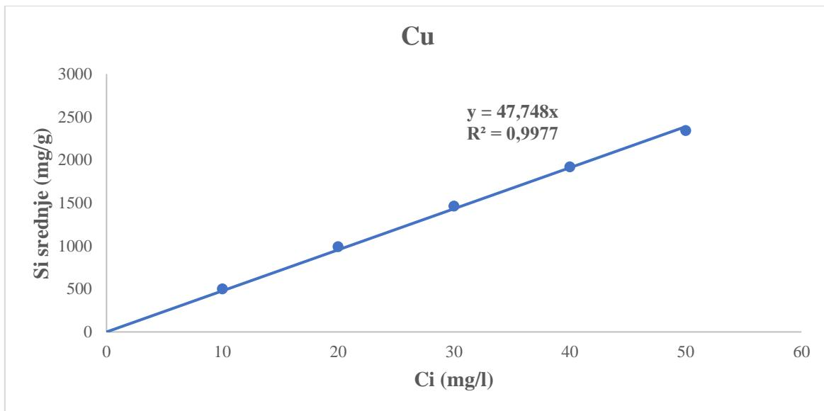
Slika 4. 6. Krivulja linearne izoterme za Cu za uzorak 6315.
