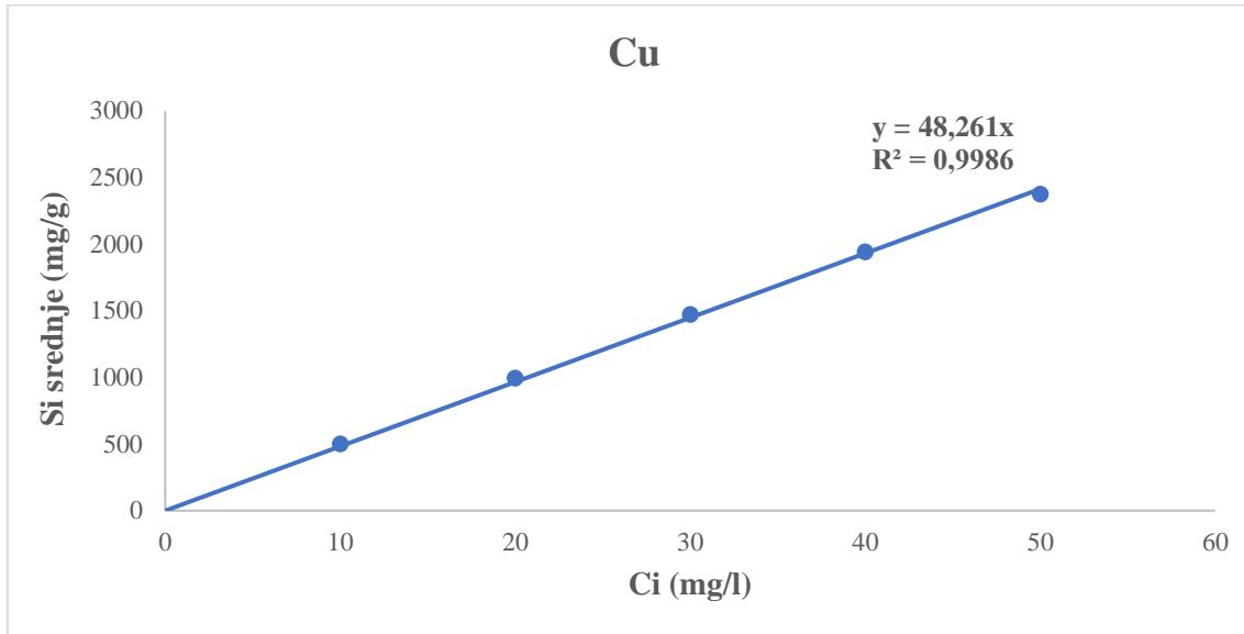
Slika 4. 3. Krivulja linearne izoterme za Cu za uzorak 6312.
