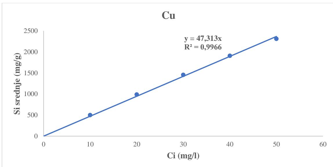
Slika 4. 8. Krivulja linearne izoterme za Cu za uzorak 6317.
