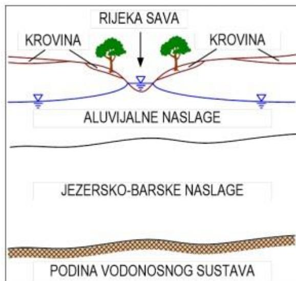
Slika 2. 3. Shematski profil zagrebačkog vodonosnog sustava (Posavec, 2006).
