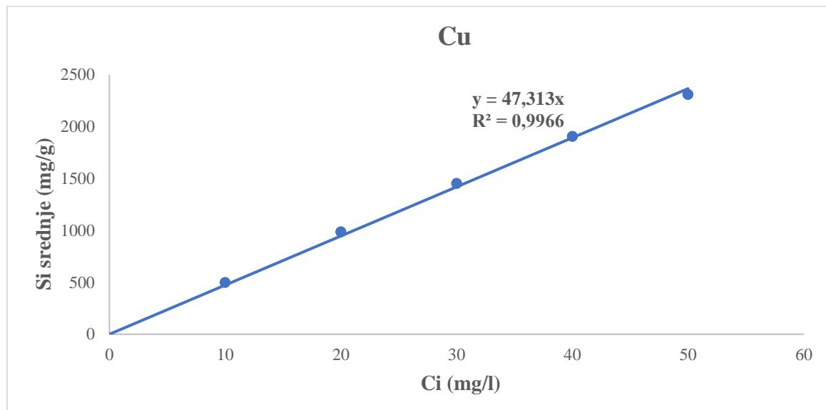
Slika 4. 1. Krivulja linearne izoterme za Cu za uzorak 6310.
