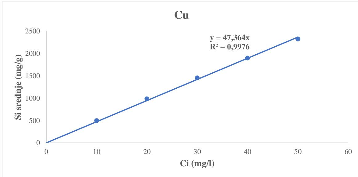
Slika 4. 7. Krivulja linearne izoterme za Cu za uzorak 6316.
