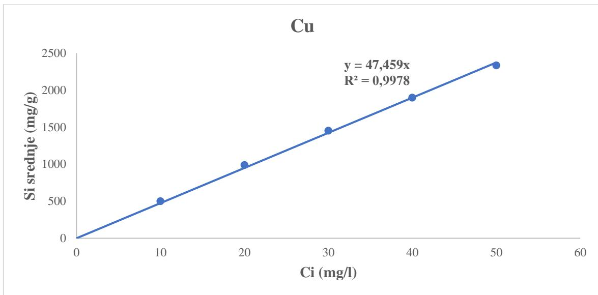
Slika 4. 4. Krivulja linearne izoterme za Cu za uzorak 6313.
