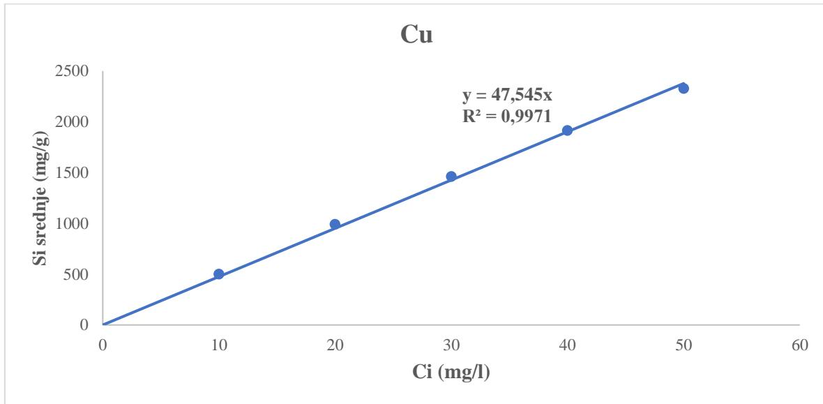
Slika 4. 5. Krivulja linearne izoterme za Cu za uzorak 6314.
