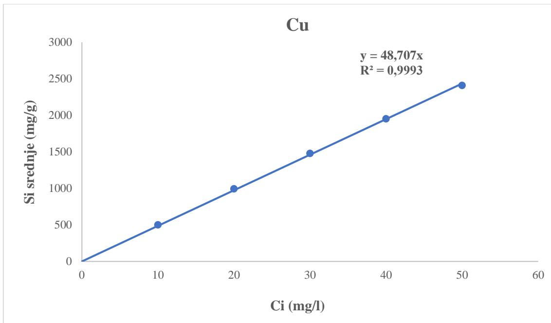
Slika 4. 2. Krivulja linearne izoterme za Cu za uzorak 6311.
