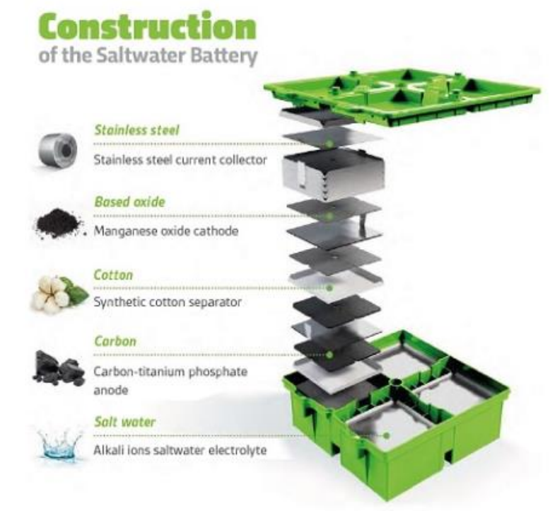
Slika 4-12. Konstrukcija natrij-ionske baterije (Izvor: GreenRock)
