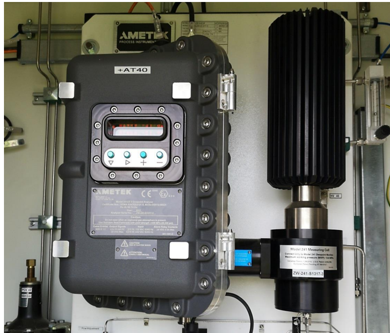
Slika 5-11. Ametek, analizator za mjerenje rosišta ugljikovodika
