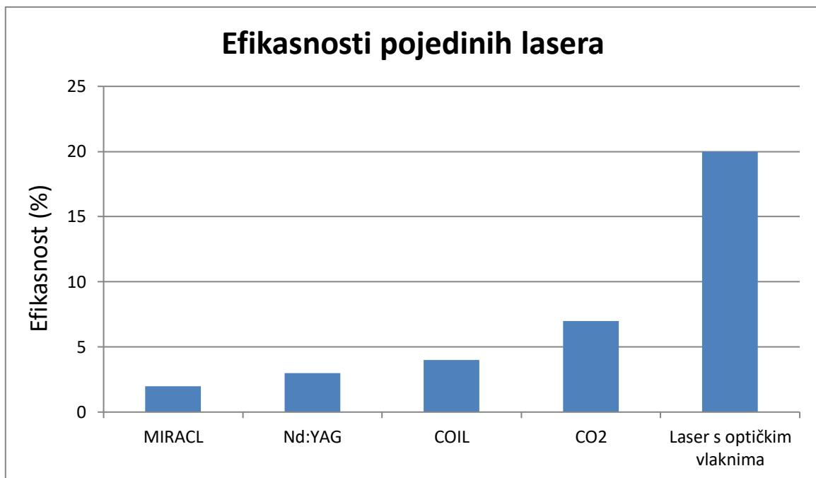
**Slika 3-1.** Efikasnosti pojedinih lasera (Batarseh et al., 2005)
