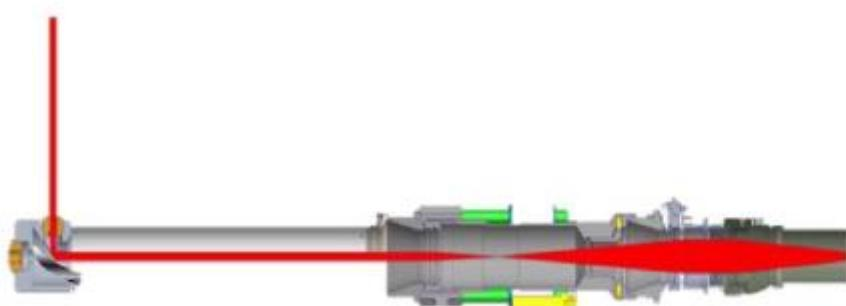
**Slika 6-9.** Laserska puška orijentirana bočno za perforiranje stijene (Batarseh et al., 2019)
