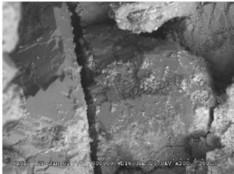
**Slika 4-4.** Pukotina u zrncu kvarca stvorena nakon djelovanja topline na uzorak (uslikano elektronskim mikroskopom) (Batarseh et al., 2003)
