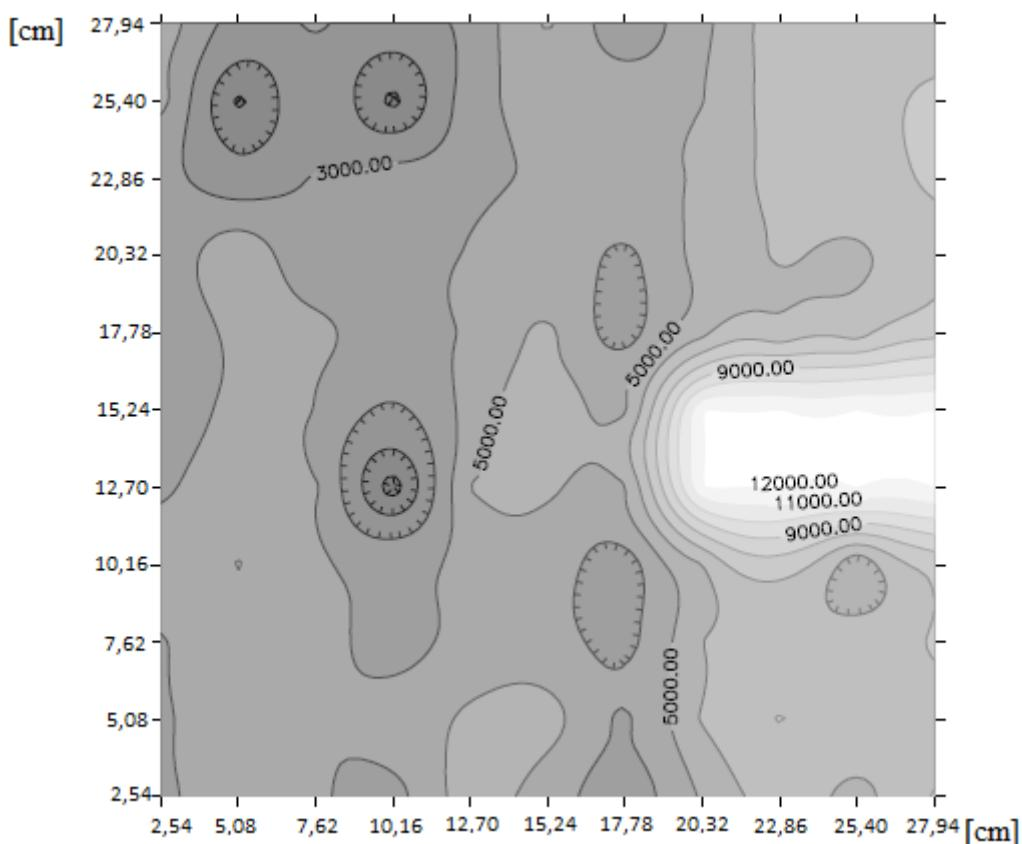
**Slika 4-3.** Konturna karta propusnosti uzorka Berea pješčenjaka dobivena mjeranjem prije i nakon djelovanja kemijskog deuterij-fluorid lasera (Batarseh et al., 2003)
