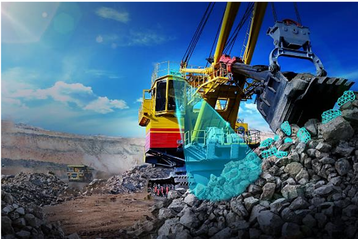
Slika 3-8 Autonomni sustav za određivanje fragmentacije odminiranog materijala na bageru ( Mining.com , 2019a)
