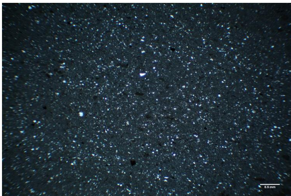
Slika 4-9. Mikropetrografski izbrusak, UZORAK Slap-3 (ukriženi nikoli)
