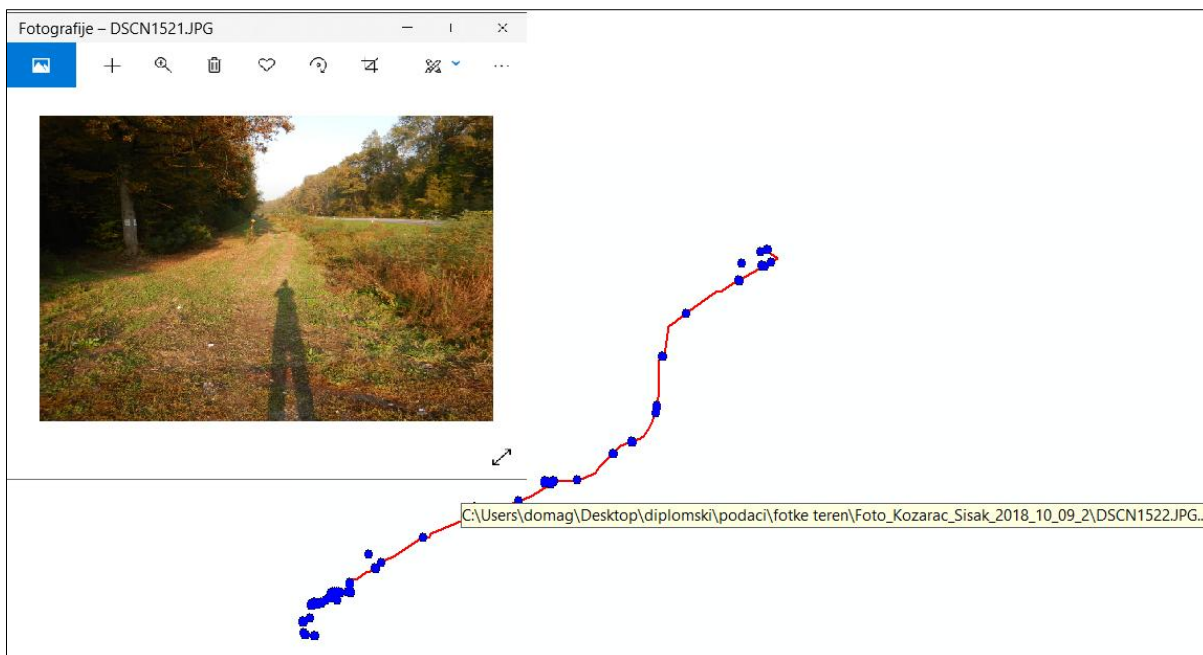
Slika 4.10. Prikaz otvaranja fotografija preko Hyperlink -a unutar ArcMap -a
