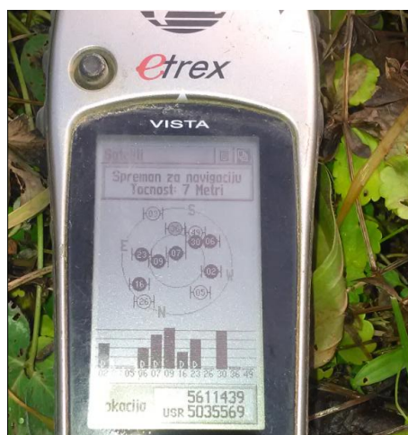
Slika 4.8. Fotografija prema kojoj su izračunate koordinate za poziciju BKS – 2 točke
