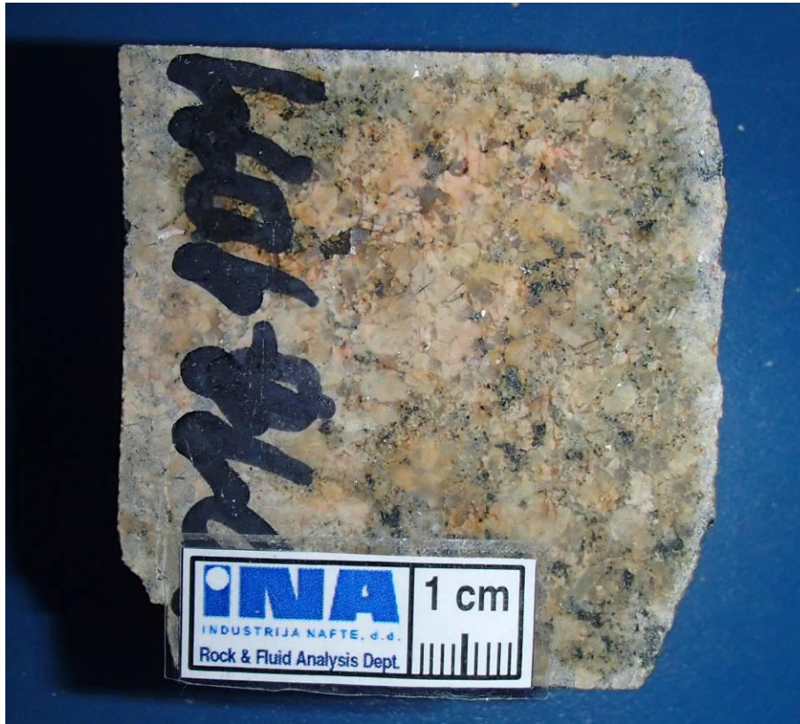
Slika 7.2 Alkalijsko-feldspatski granit s izraženom porfiroidnom strukturom. Krupnija zrna K-feldspata i kvarca okružena su granofirskim prorastanjem navedenih minerala. Vidljiv je crni intersticijski biotit te sitnozrnate nakupine hornblende, biotita i albita. Privlaka-1, J-3, interval 1010 – 1011 m.
