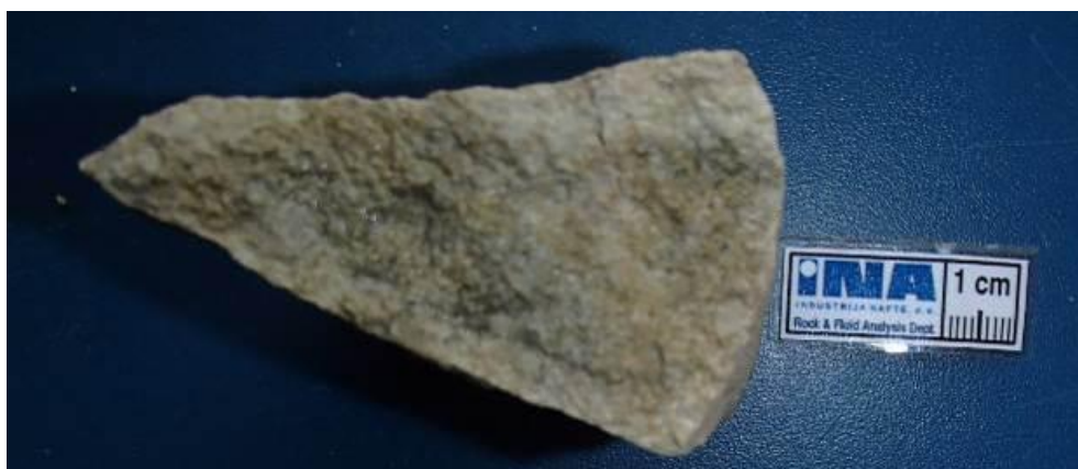
Slika 7.24 Riolit sferulitne teksture. Županja-3, J-2, interval 1427 – 1430 m.
