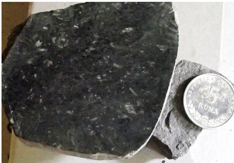
Slika 7.49 Porfiroidni hornblenda dijabaz. Bušotina Lacići-1A, J-3, interval 2402 – 2403,1 m.
