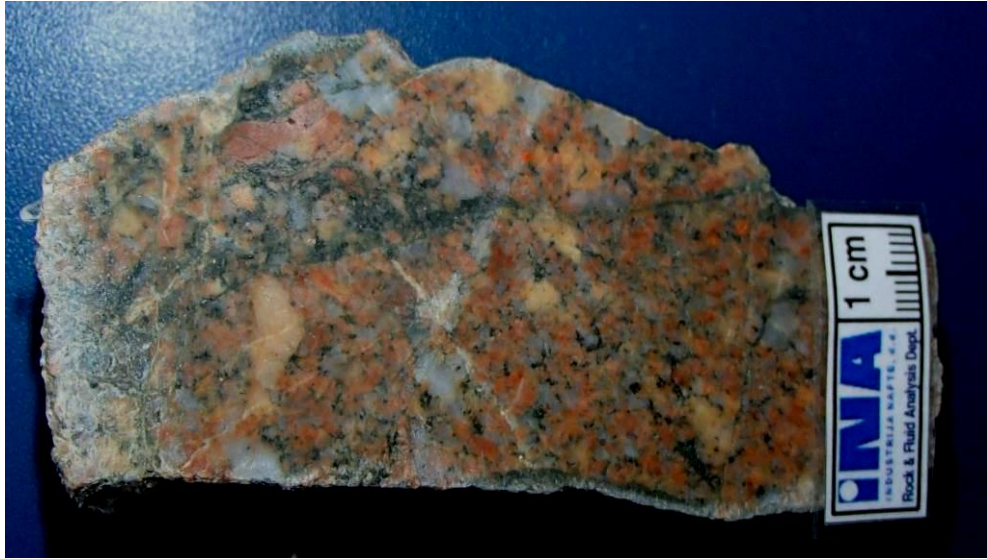
Slika 7.21 Kataklastična tekstura u porfiroidnom granitu. Županja-3, J-2, interval 1427 – 1430 m.
