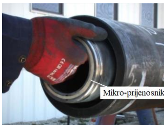
Slika 6-9. Mikro-prijenosnik u ženskoj spojnici bušaće šipke (Macpherson et al., 2019)
