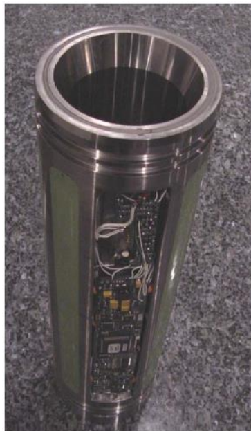
Slika 6-4. Alatka s ugrađenim pojačivačem signala (Reeves et al., 2005)
