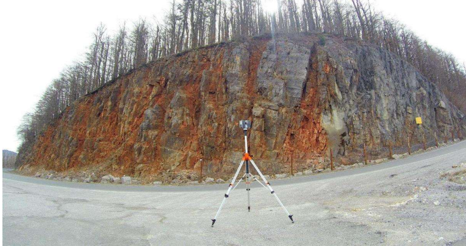
Slika 4-1 Snimanje stijenskog pokusa metodom terestričkog laserskog skeniranja (Đikić, 2016.).
