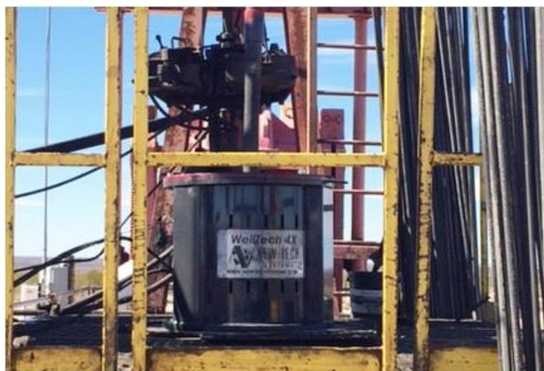
**Slika 3-11.** Uredaj za inspekciju tubinga prilikom njegovog izvlačenja iz bušotine na površinu ([www.newtechsystems.com](http://www.newtechsystems.com), 24.3.2020.)
