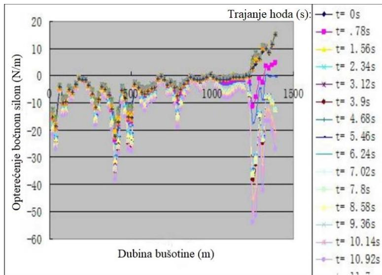
**Slika 3-3.** Odnos opterećenja bočne sile i dubine bušotine kod sisaljki promjera 57,2 mm
