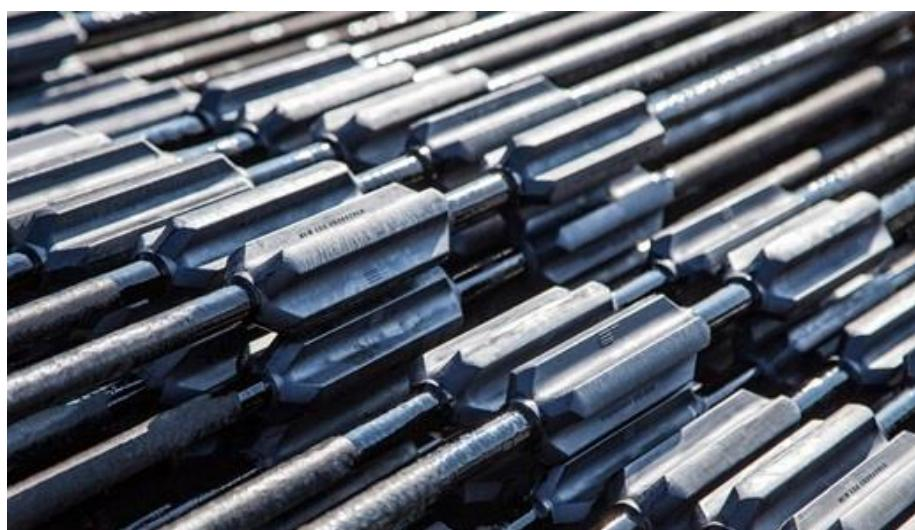
**Slika 5-1.** Centralizeri na klipnim šipkama ([www.nov.com](http://www.nov.com), 31.3.2020.)
