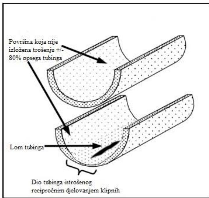
**Slika 3-6.** Oštećenje stijenki tubinga uslijed mehaničkog trošenja (Hart, 2003)
