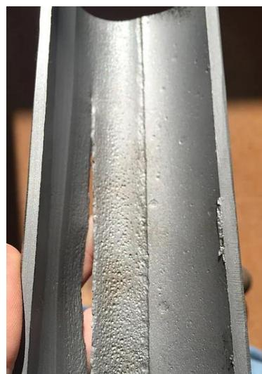
**Slika 3-7.** Slika pukotine nastale mehaničkim trošenjem (production-technology.org/tubing-rotator, 10.12.2019.)
