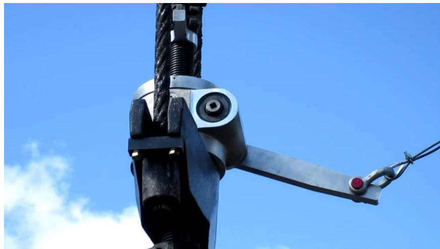
**Slika 5-5.** Rotator klipnih šipki s mehaničkim rotacijskim mehanizmom
