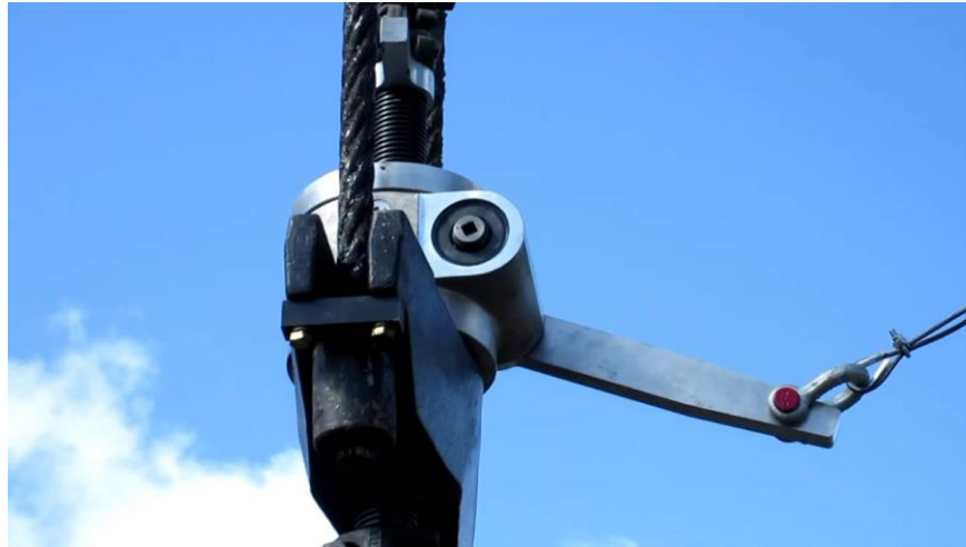
Slika 5-5. Rotator klipnih šipki s mehaničkim rotacijskim mehanizmom (mivaengineering.ca, 31.3.2020.)
