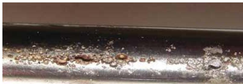
**Slika 3-8.** Slika oštećenja tubinga nastalih korozijskim trošenjem (www.offshore-mag.com, 31.3.2020.)
