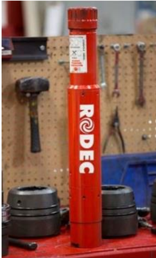
Slika 4-11. Rotacijska glava (pjoperating.com, 10.12.2019.)
