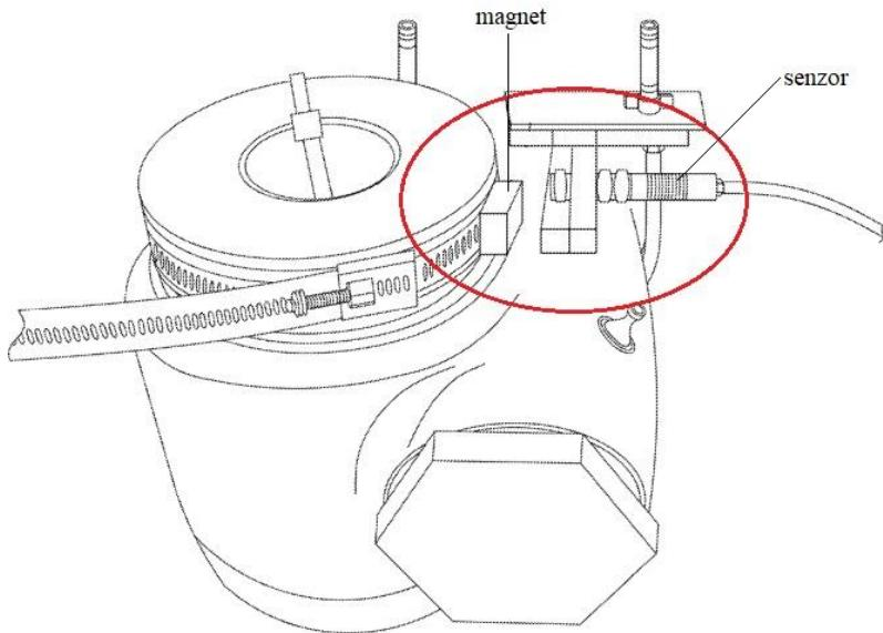
**Slika 5-6.** Senzori za praćenje rotacije glatke šipke
