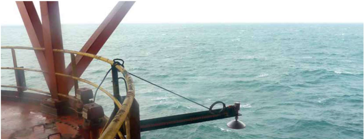
Slika 4-1. Uporaba radarskog mjernog pretvornika razine za određivanje visine vode (Vega, 2020)
