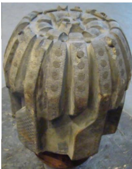
Slika 3-3. Istrošeno dlijeto (Huusgard et al, 2015)
