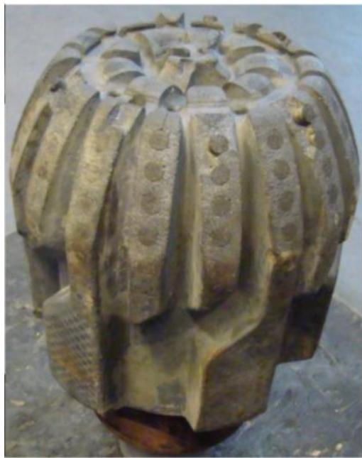
**Slika 3-3.** Istrošeno dlijeto (Huusgard et al, 2015)
