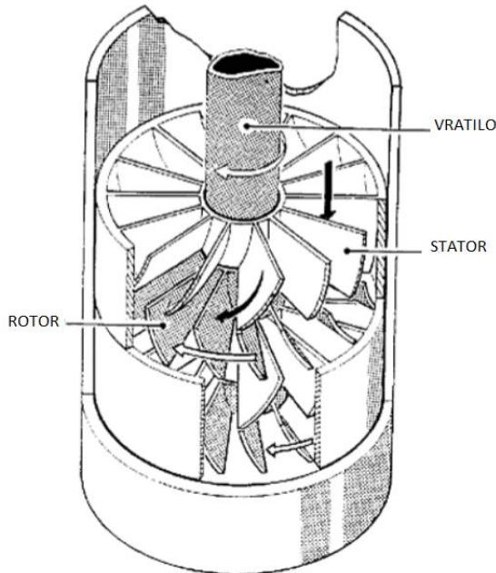
Slika 2-1. Presjek jednog stupnja turbineske bušilice ([www.drillingformulas.com](http://www.drillingformulas.com),
