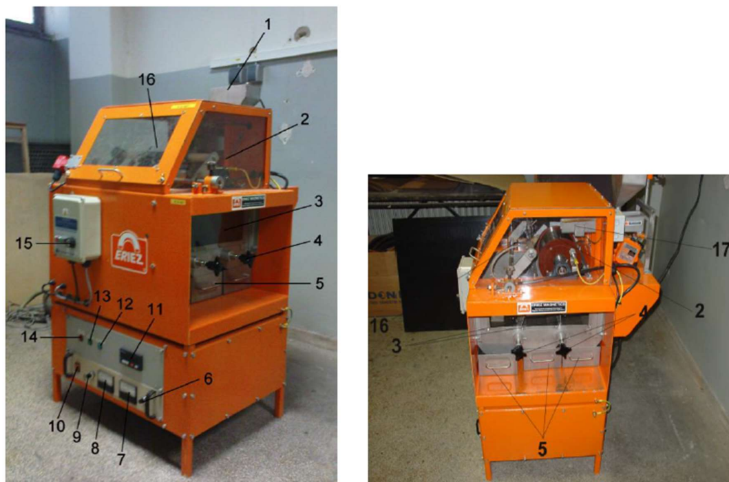
Slika 6-6 Elektrostatički separator Eriez Magnetics HT-150 (Bedeković i Salopek, 2010)
