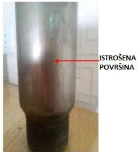
Slika 4 - 1. Istrošena metalna površina klipa sisaljke (Maher, 2016)
