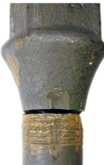
Slika 4 - 2. Oštećenje klipne šipke (Maher, 2016)
