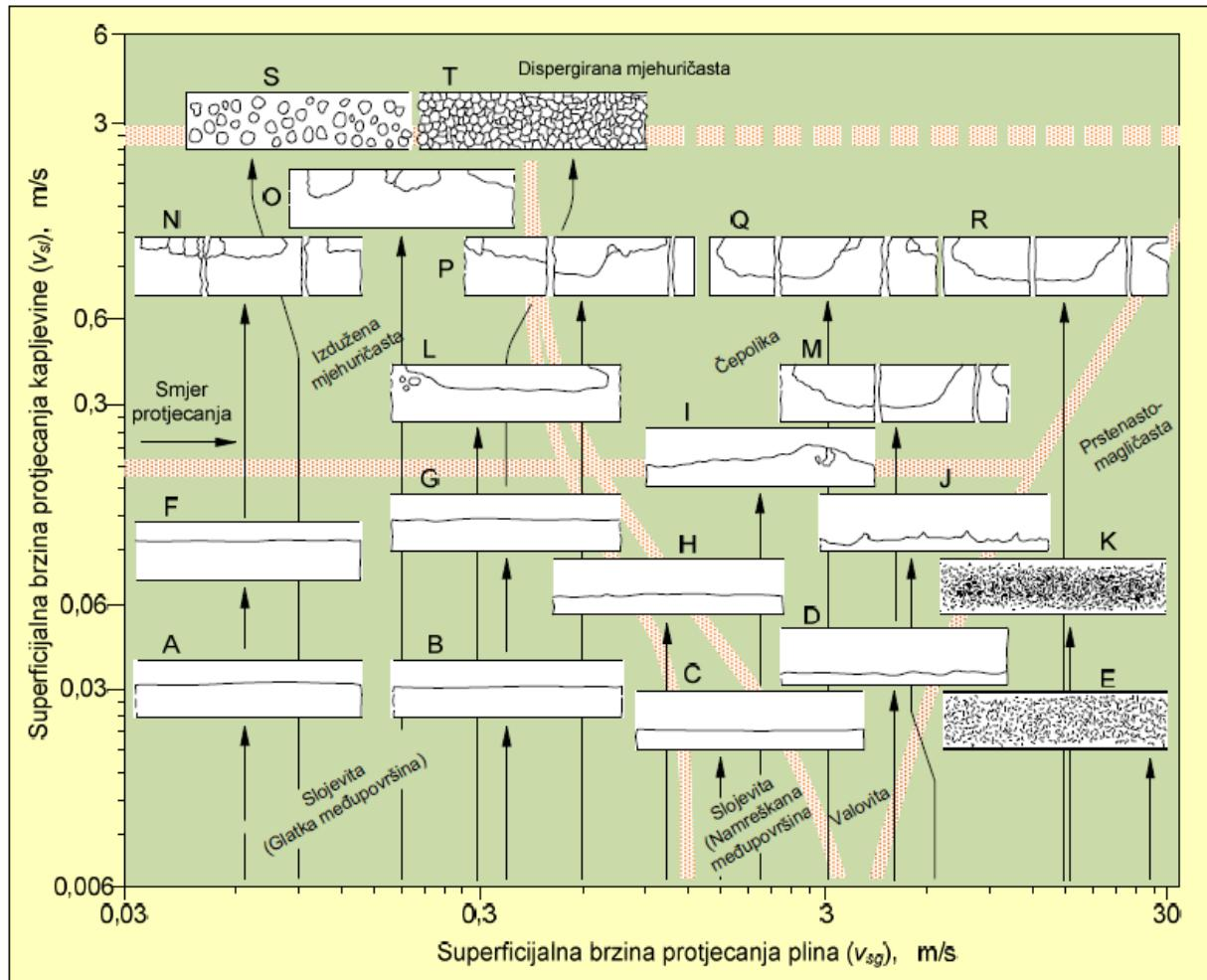
**Slika 4-3.** Strukture horizontalnog dvofaznog protjecanja u funkciji superficialnih brzina
