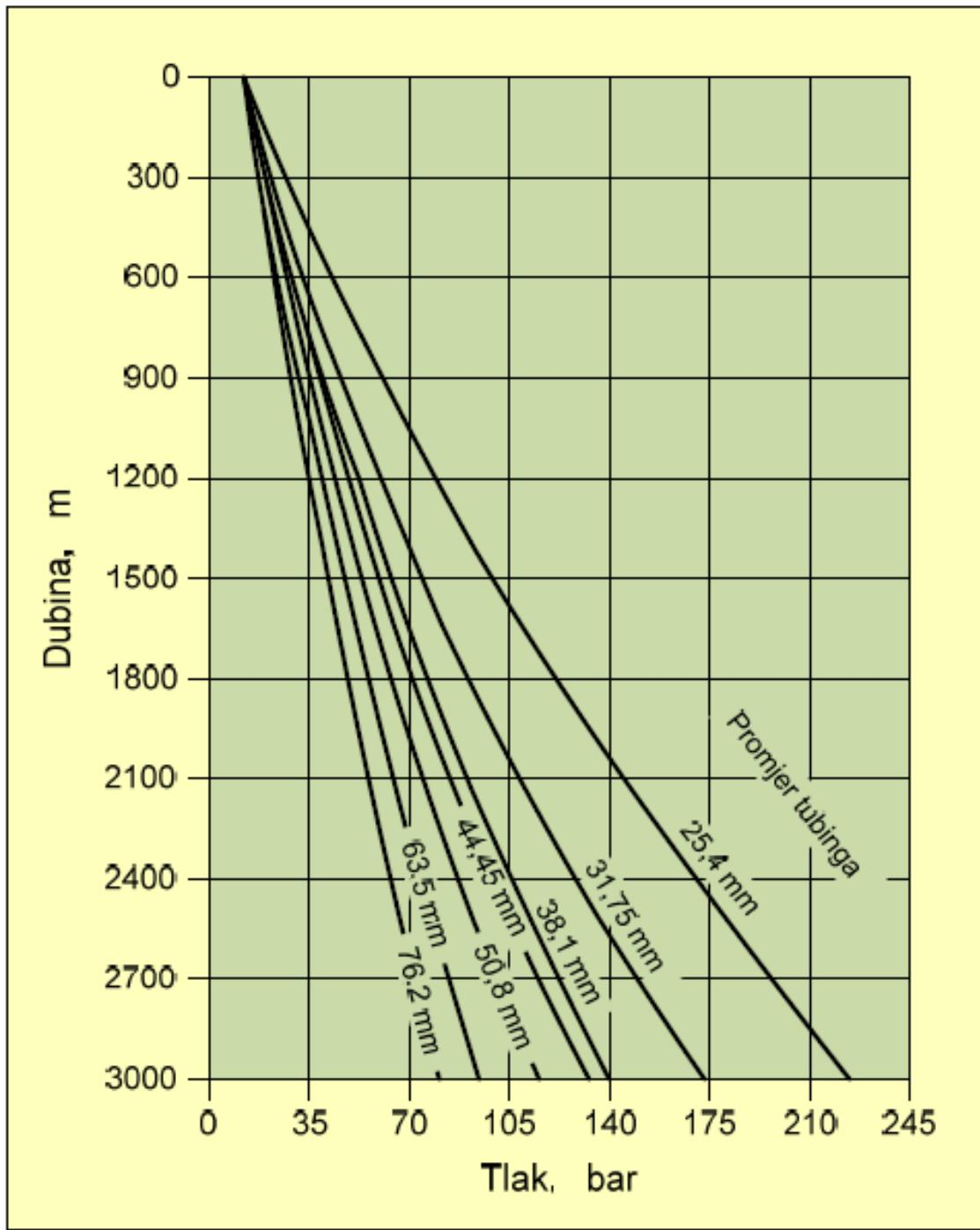
**Slika 5-6.** Utjecaj promjera tubinga na gradijent tlaka, odnosno na dinamički tlak u bušotini
