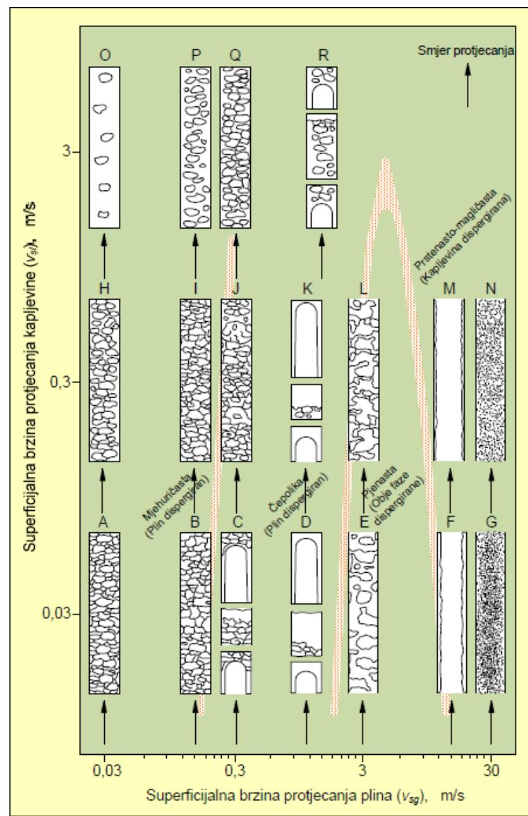
**Slika 4-2.** Strukture vertikalnog dvofaznog protjecanja u funkciji superficialnih brzina
