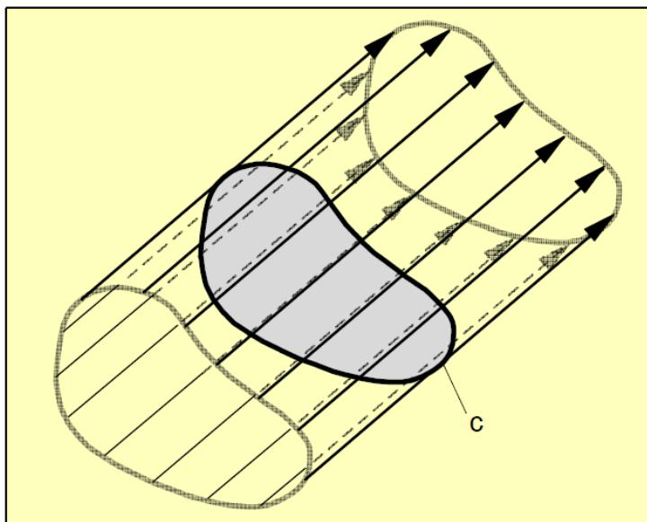
Slika 2-1. Strujnice i strjuna cijev (Čikeš 2015)
