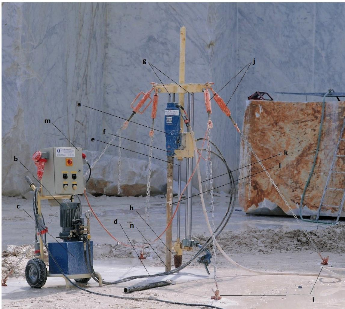
**Slika 2.3.** Osnovi dijelovi hidraulične rotacijske bušilice (Lochtmans, 2008)
