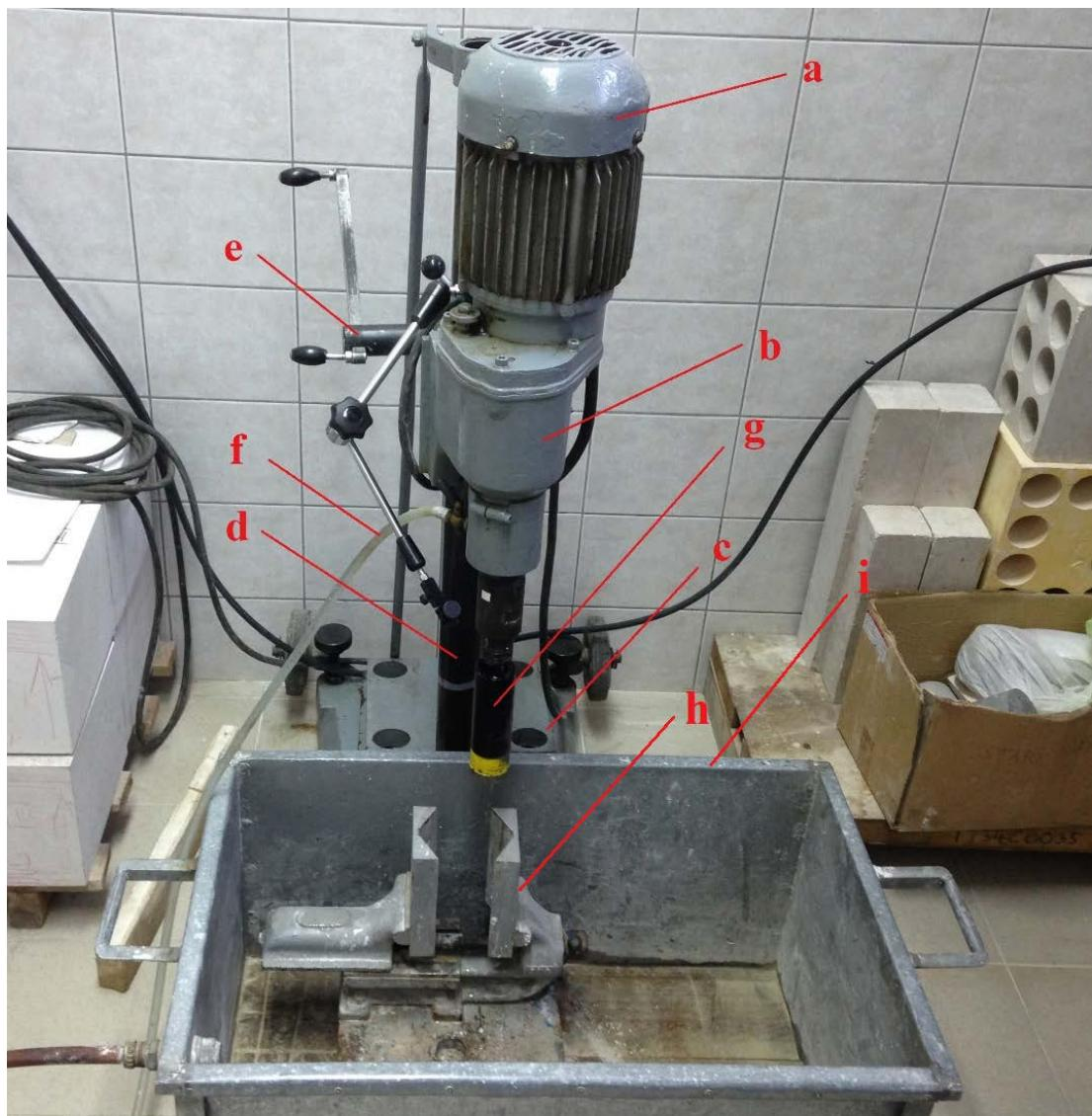
**Slika 3.4.** Osnovni dijelovi preinačene laboratorijske bušilice
