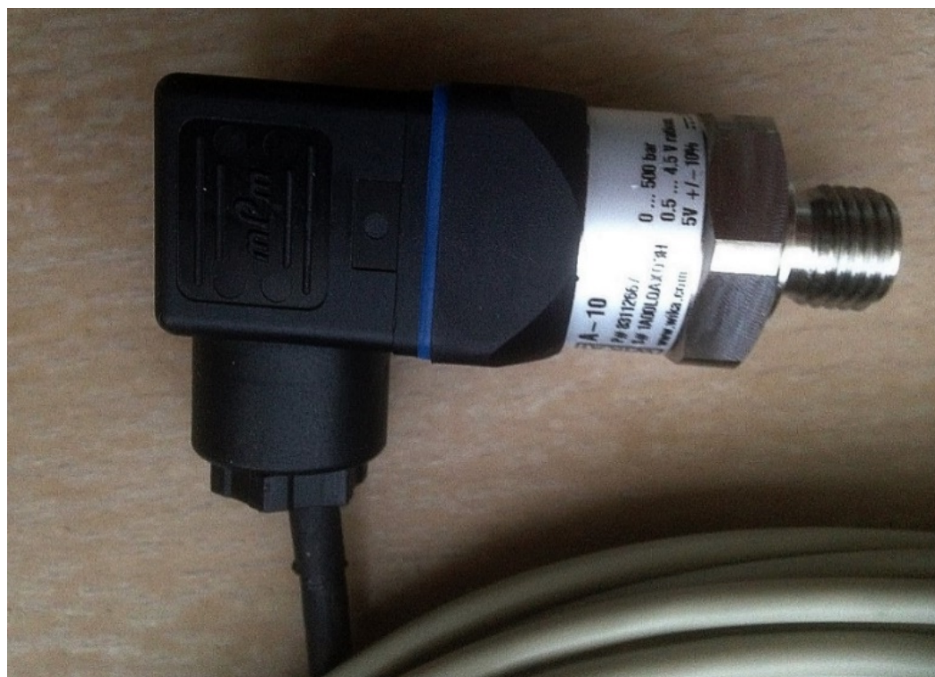
Slika 3.57. Osjetilo za mjerenje tlaka WIKA, Model A-10
