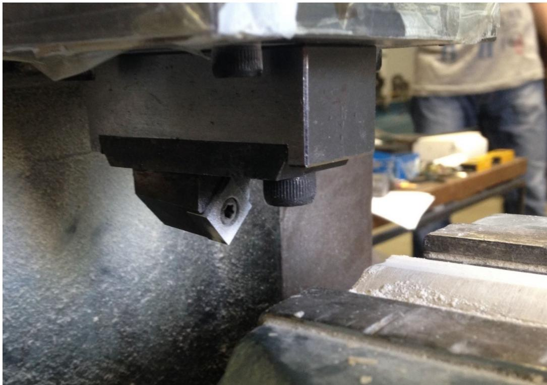
**Slika 3.3.** Nosač s reznom pločicom PM0
