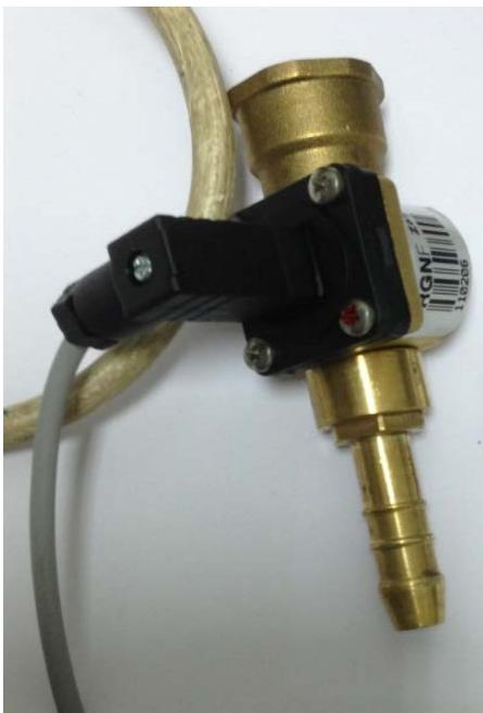
**Slika 3.49.** Osjetilo za mjerjenje protoka vode FCH-C-Ms-N s holender maticama
