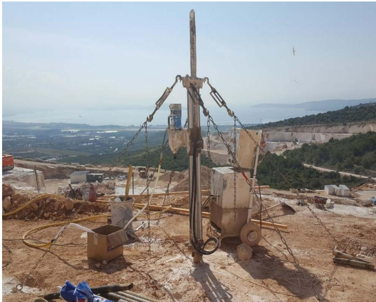
**Slika 3.53.** Hidraulična rotacijska bušilica Lochtmans LGR FAST65
