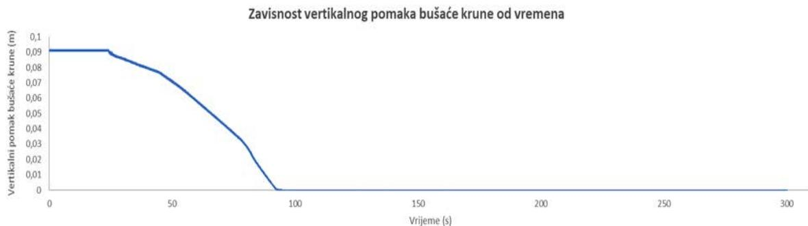
**Slika 4.16.** Dijagram zavisnosti vertikalnog pomaka bušaće krune od vremena (prvo mjerjenje)
