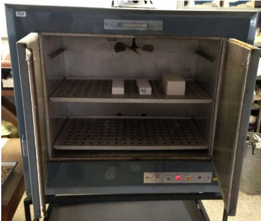
Slika 3.45. Sušionik sa stijenskim uzorcima
