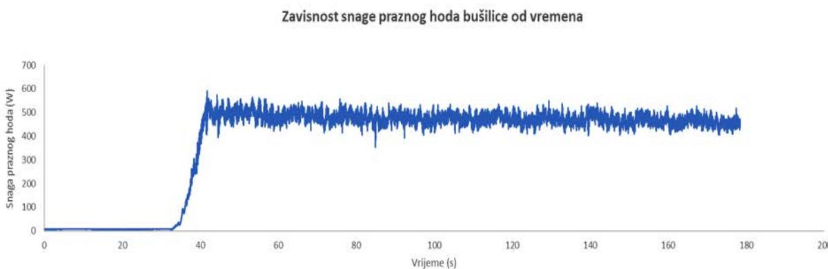
**Slika 4.13.** Dijagram zavisnosti snage praznog hoda bušilice od vremena (prvo mjerjenje)
