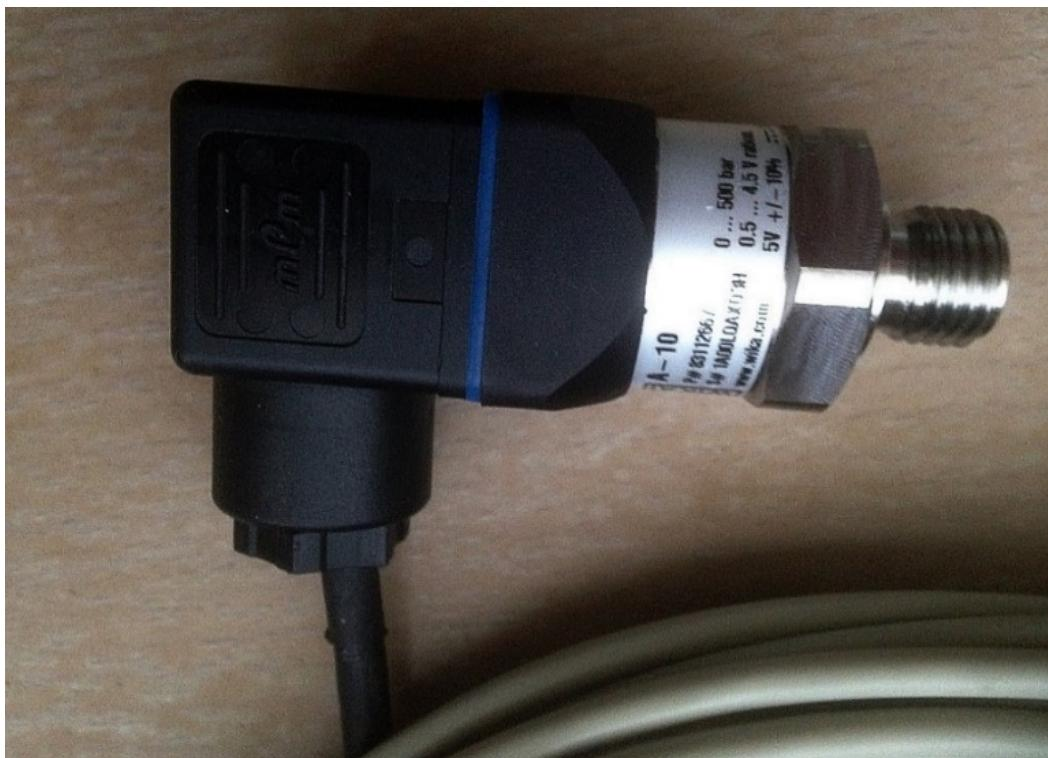
Slika 3.57. Osjetilo za mjerjenje tlaka WIKA, Model A-10
