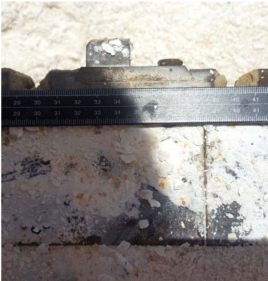
Slika 3.63. Mjerenje duljine članka reznog lanca lančane sjekačice
