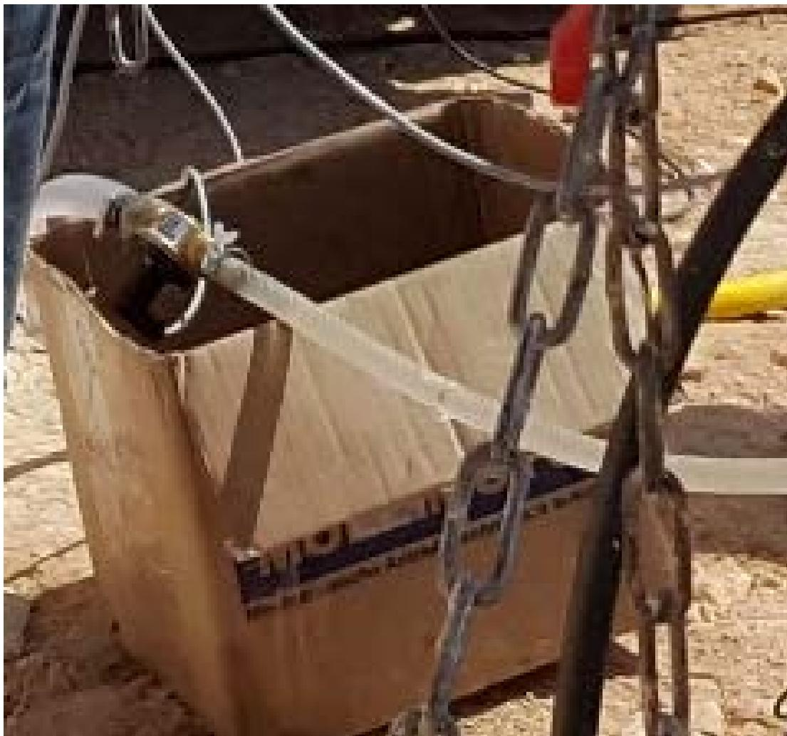
**Slika 3.66.** Osjetilo za mjerjenje protoka spojeno na plastični cjevovod za dovod vode
