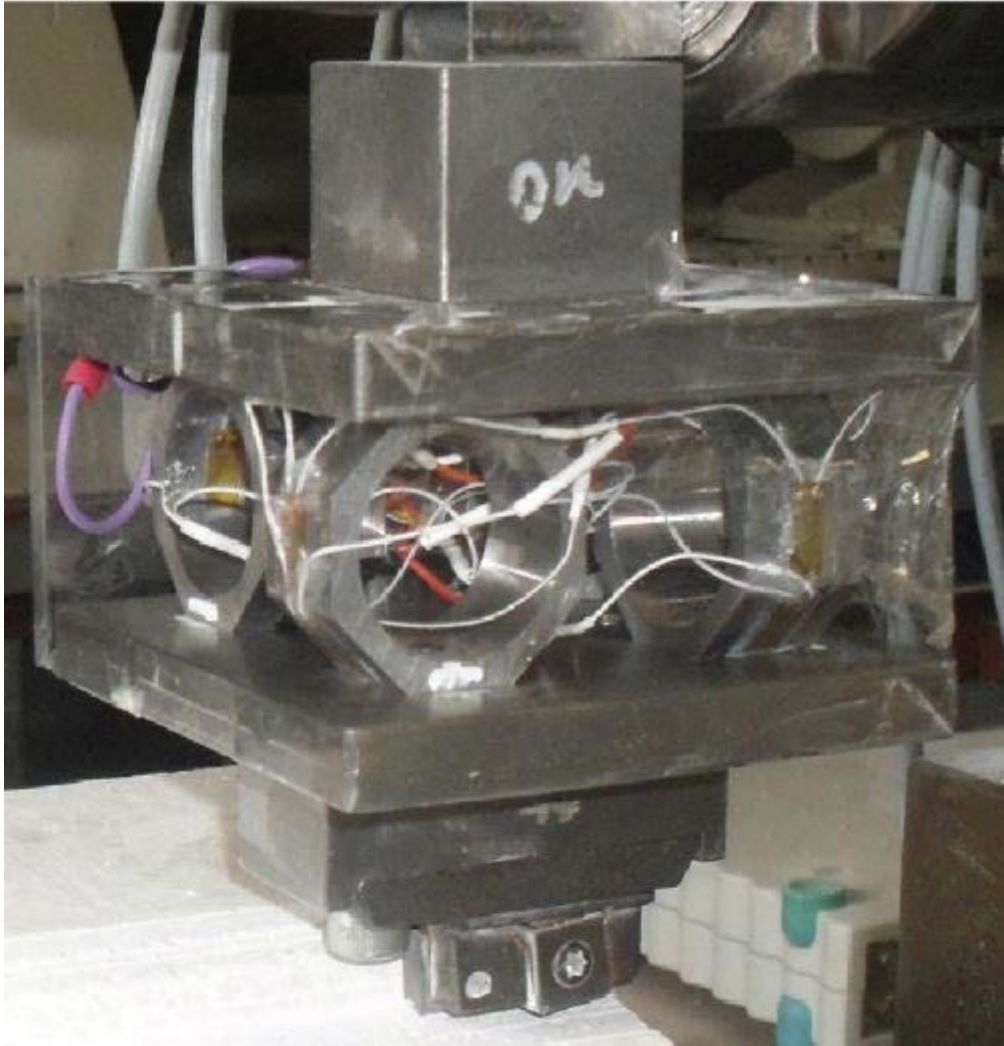
Slika 3.16. Troosni mjerni pretvornik sile s elektrootpornim trakama (Korman, 2014)
