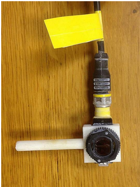
Slika 3.41. Osjetilo za mjerenje broja okretaja World-Beam QS18LLP
