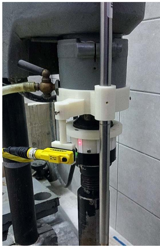
**Slika 3.40.** Nosač LVDT-a i osjetila za mjerjenje broja okretaja postavljen na kućište bušilice
