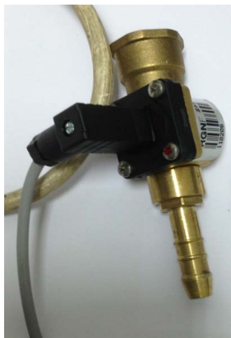
Slika 3.49. Osjetilo za mjerenje protoka vode FCH-C-Ms-N s holender maticama
