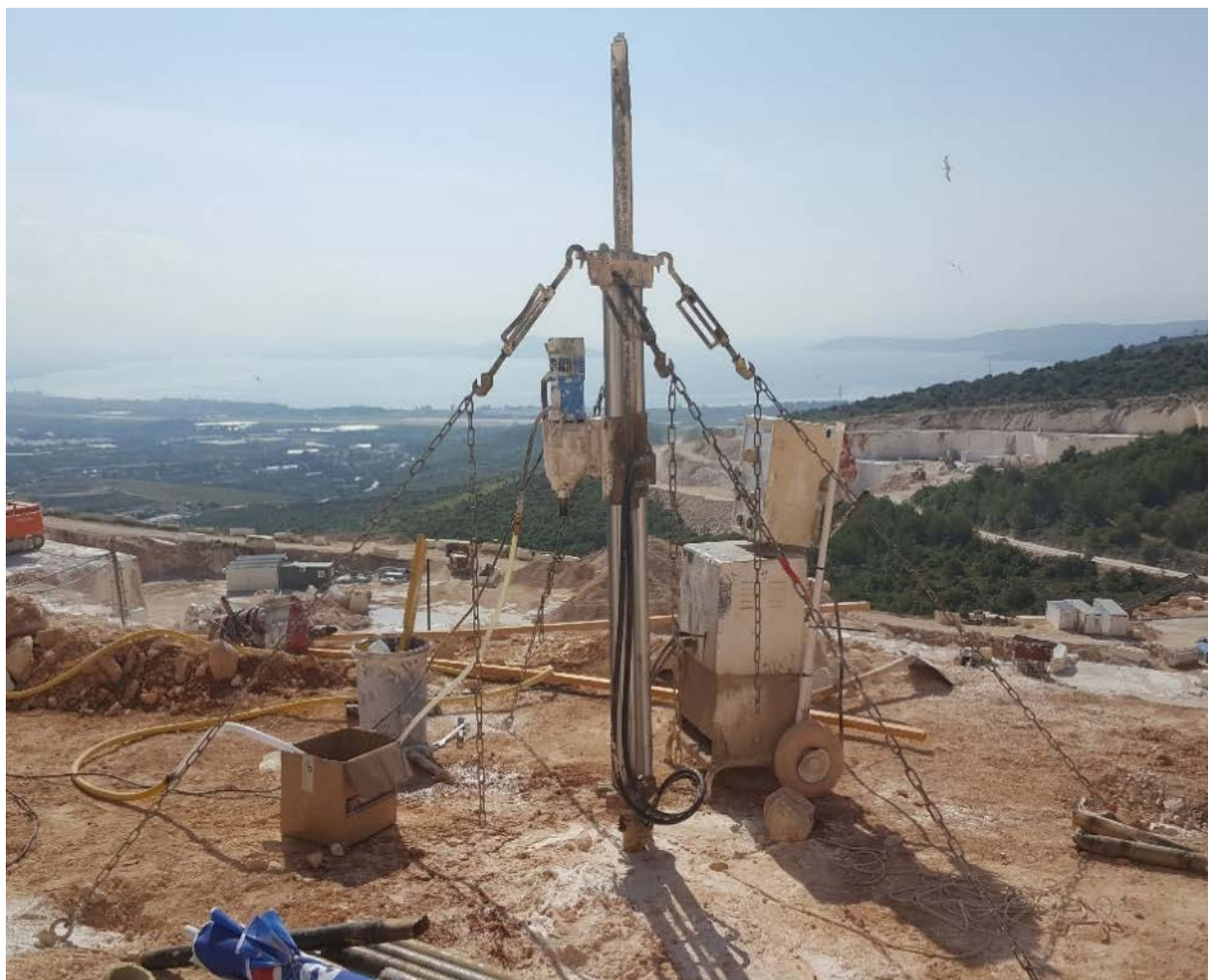
Slika 3.53. Hidraulična rotacijska bušilica Lochtmans LGR FAST65
