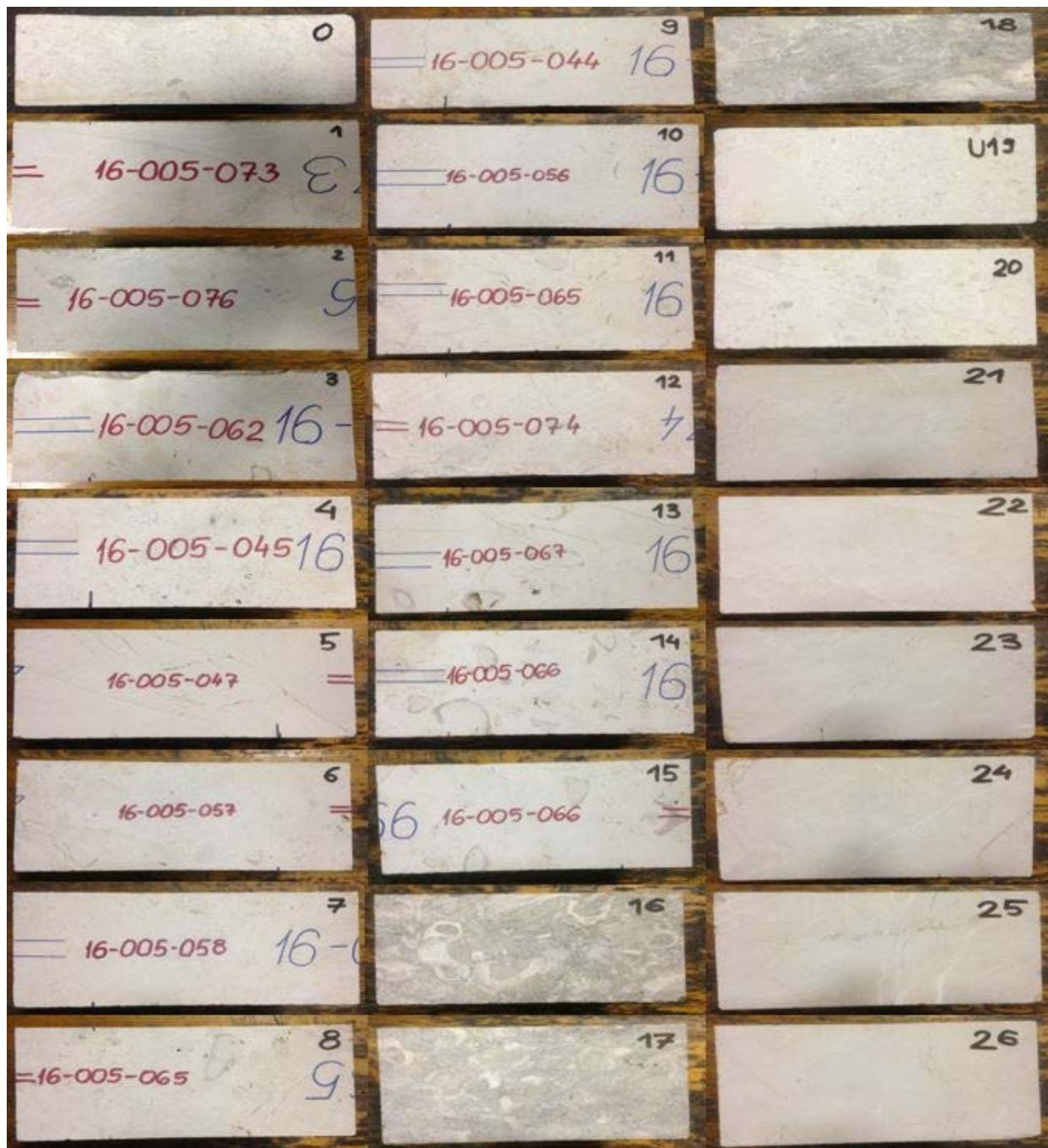
Slika 3.6. Stijenski uzorci na kojima su provedena laboratorijska ispitivanja
