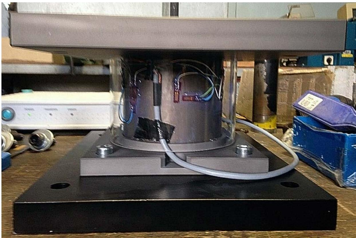
Slika 3.33. Osjetilo za mjerjenje vertikalne komponente sile bušenja i okretnog momenta
