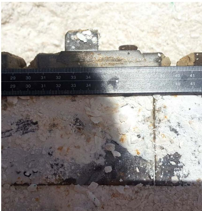
**Slika 3.63.** Mjerjenje duljine članka rezognog lanca lančane sjekačice
