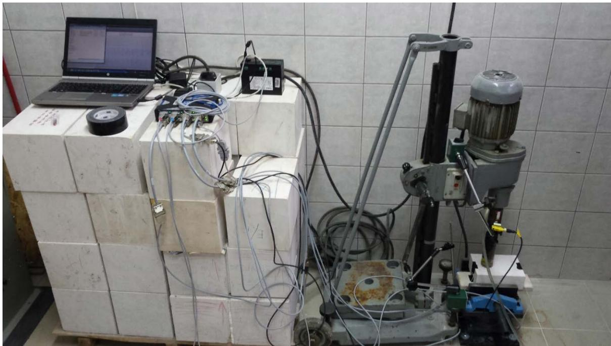
**Slika 3.15.** Mjerni sustav za mjerjenje snage te mjerni sustav s mjernim pretvornikom sile i okretnog momenta spojeni na laboratorijsku bušilicu
