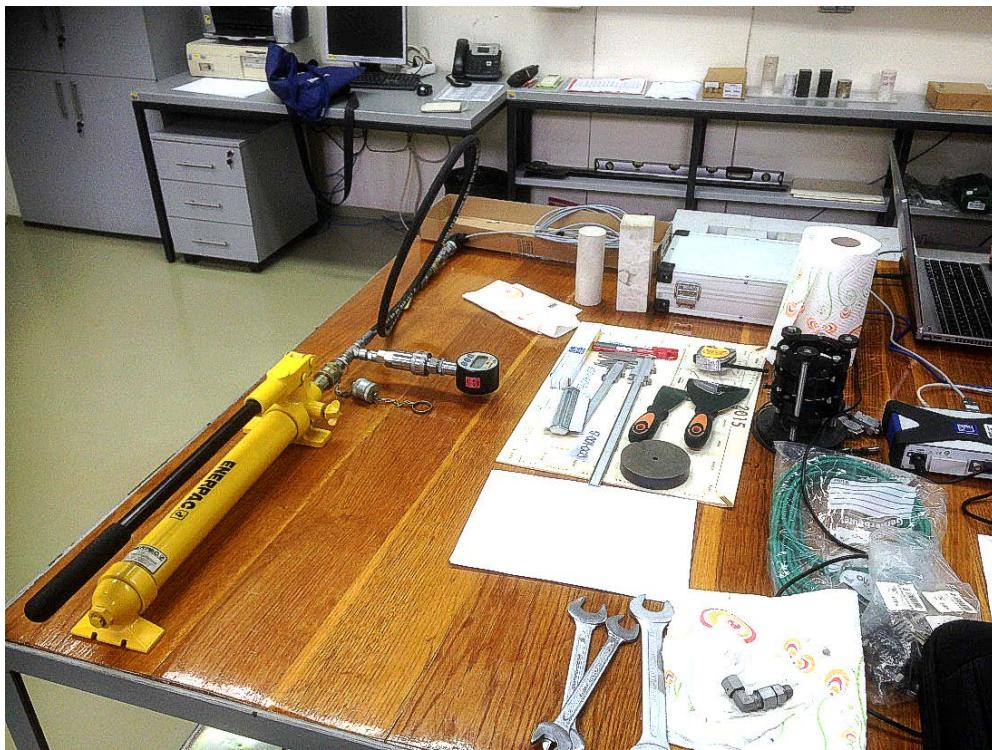
**Slika 3.59.** Testiranje osjetila za mjerjenje tlaka na hidrauličnoj preši Enerpac P39
