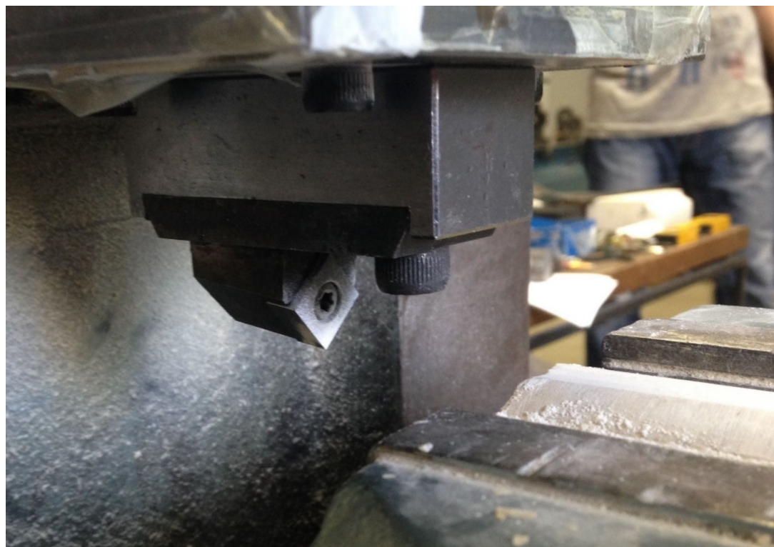
Slika 3.3. Nosač s reznom pločicom PM0
