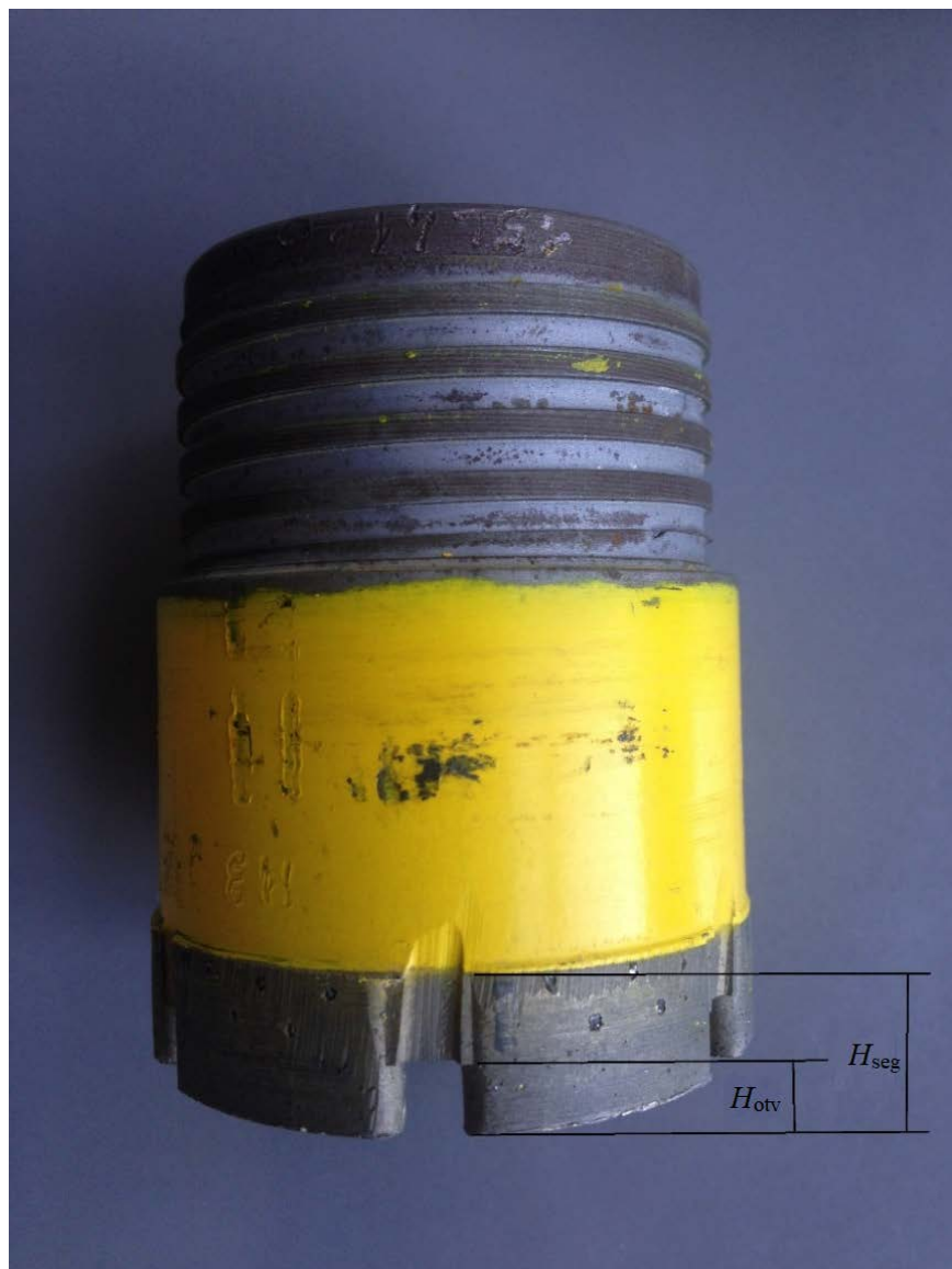
Slika 3.5. Bušaća kruna Atlas Copco
