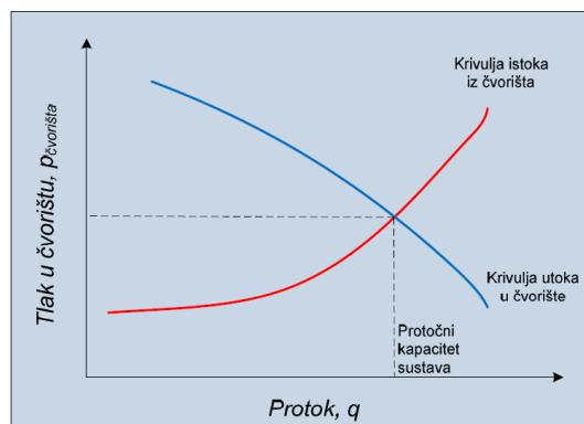
**Slika 2- 3.** Određivanje protočnog kapaciteta sustava (Čikeš, 2015)
