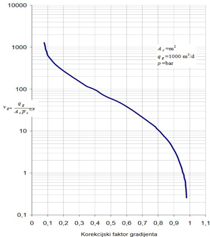
**Slika 5- 1.** Podjeva krivulja za korekcijski faktor gradijenta tlaka stupca fluida u prstenastom prostoru bušotine (Zelić i Čikeš, 2006)
