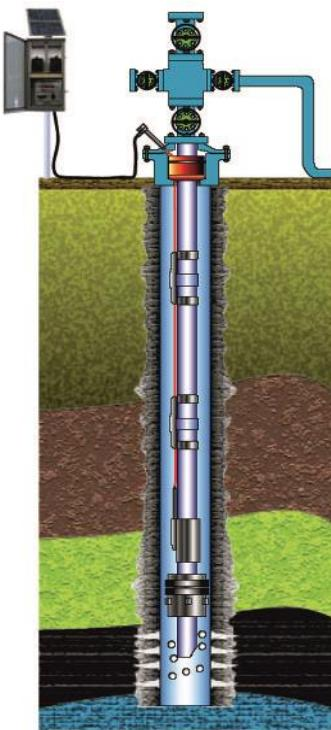
**Slika 5- 3.** Proizvodni niz opremljen permanentnim dubinskim manometrom
