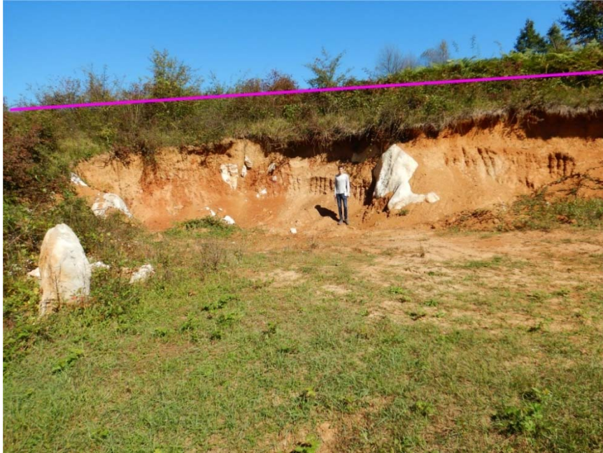
Slika 4-12 Trasa plinovoda na približno st. 6+060 na kojoj se vidi paleodepresija u srednjejurskim vapnencima koja je ispunjena crvenim boksitičnim glinama (Calx, 2019)
