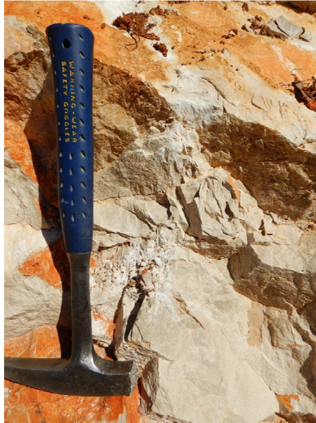
Slika 4-13 Vapnenac svrstan u IV./VI. kategoriju iskopa prema BRAUN-STINY -evoj tehničkoj klasifikaciji
