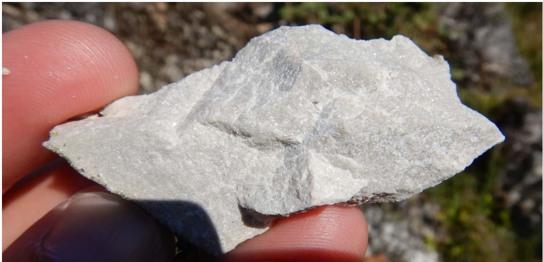
Slika 3-6 Uzorak s lokacije BS-8, vapnenac svijetlije sive boje i oštrobridnog loma
