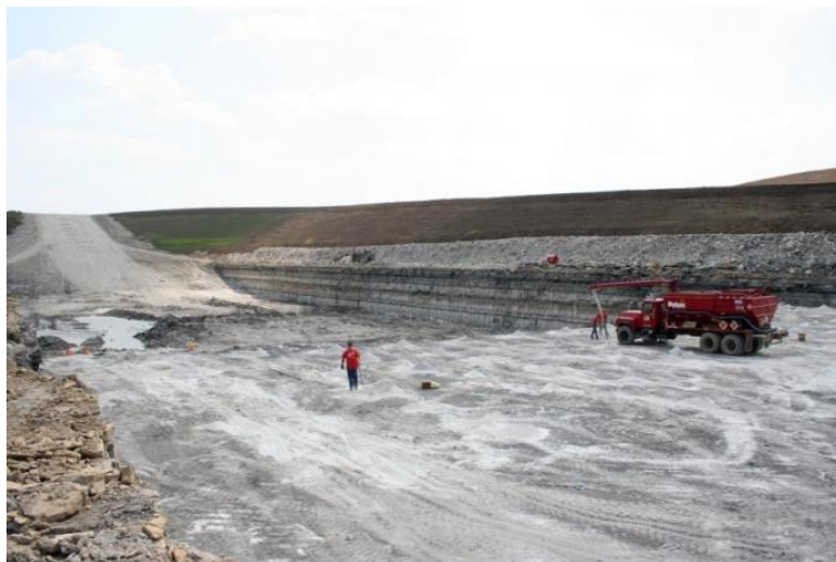
Slika 3-4. Proizvodnja ANFO eksploziva na mjestu upotrebe ( http://dykonblasting.com/portfolio/weeping-water-quarry-quarry-blasting/ )
