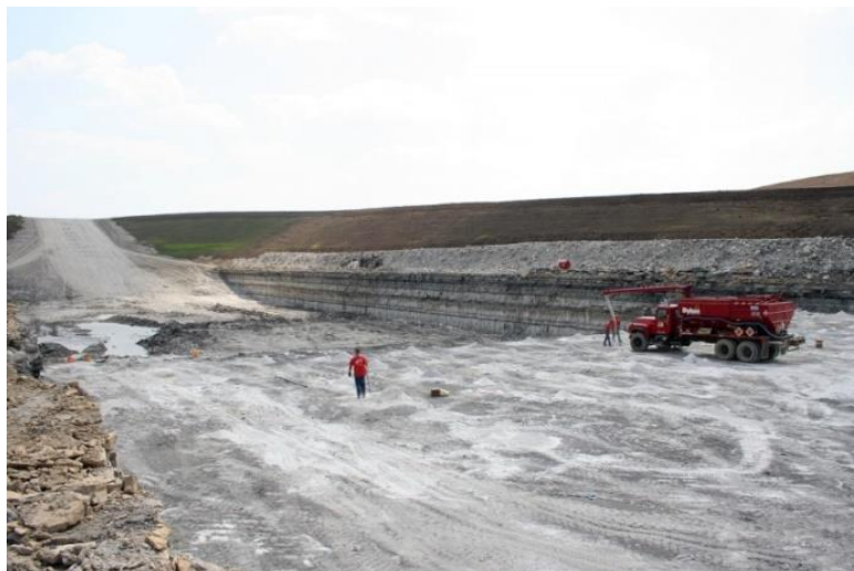
Slika 3-4. Proizvodnja ANFO eksploziva na mjestu upotrebe ( http://dykonblasting.com/portfolio/weeping-water-quarry-quarry-blasting/ )
