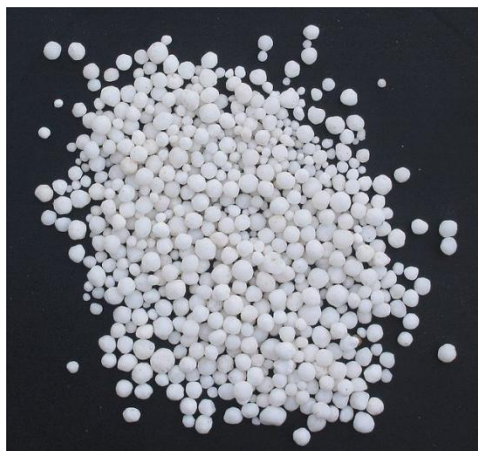
Slika 3-1. Amonijev nitrat za proizvodnju ANFO eksploziva ( https://medicroslavl.ru/ )
