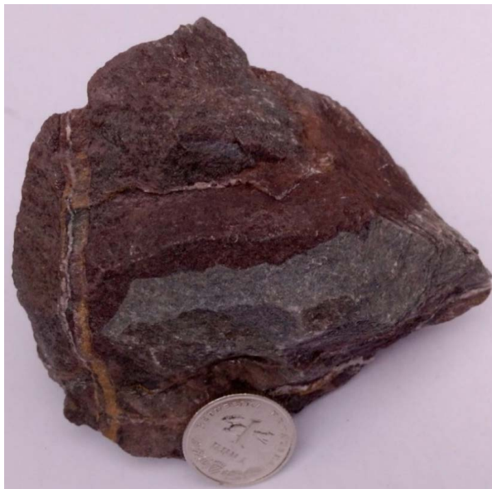
Slika 5-8. Uzorak MVIM 21B2. Crveni dijelovi uzorka su posljedica impregnacije željezovitom tvari.
