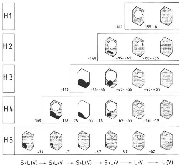
Slika 4-3. Shema faznih prijelaza homogenizacije i volumetrijskih odnosa faza u ovisnosti o promjeni temperature (Van den Kerkhof, 1988.)
