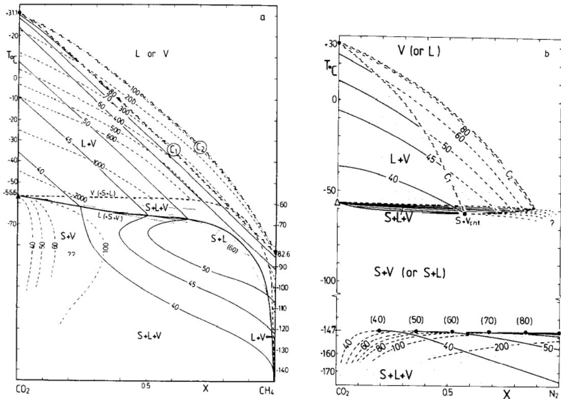
Slika 4-7. TX projekcije izohornih krivulja  $\text{CO}_2\text{--CH}_4$  (lijevo) i  $\text{CO}_2\text{--N}_2$  (desno) sustava
