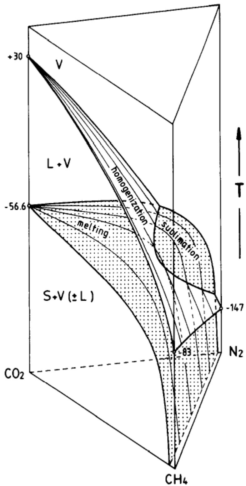
Slika 4-9. Shema 3D TX dijagrama tercijarnog sustava  $\text{CO}_2$ - $\text{CH}_4$ - $\text{N}_2$  (Van den Kerkhof, 1988.)
