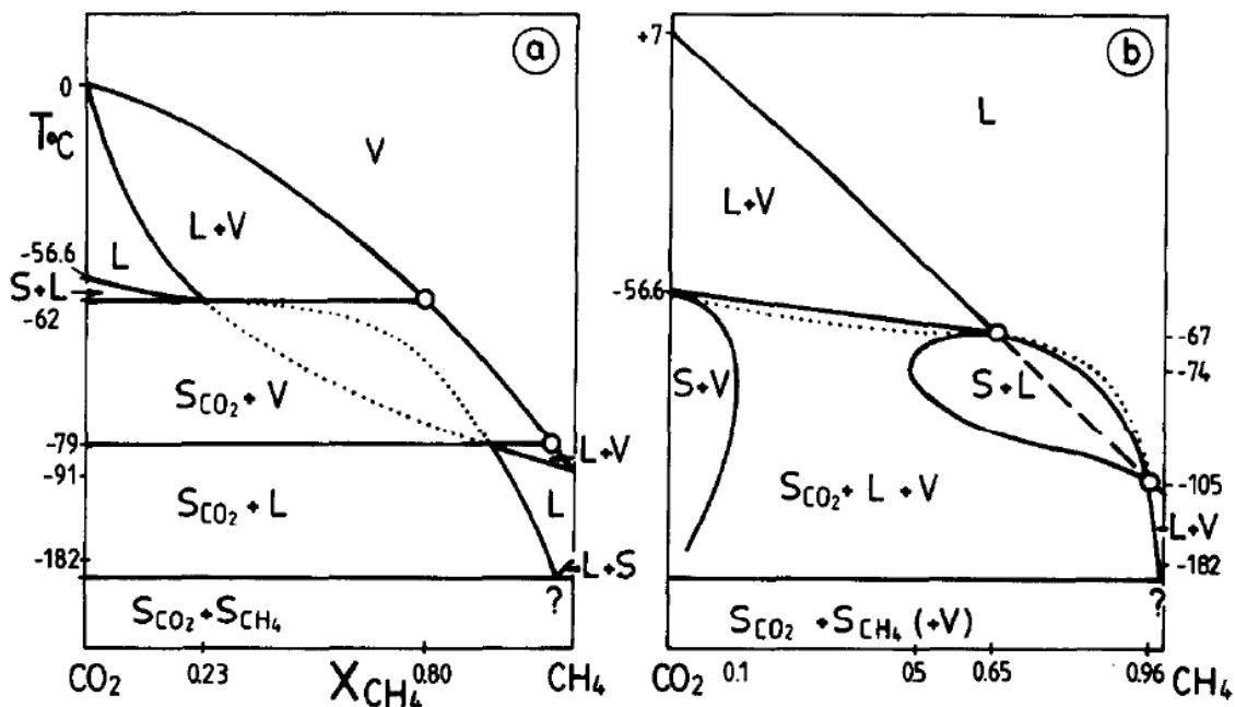
Slika 4-6. TX fazni dijagrami sustava CO<sub>2</sub>-CH<sub>4</sub> (Burruss, 1981.).
