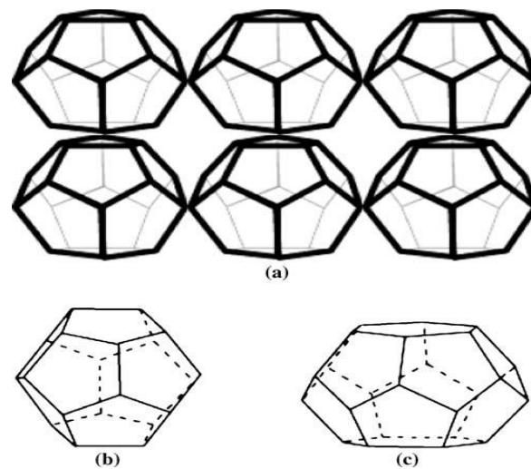
Slika 2-1. Kristalne strukture hidrata sI (Demirbas, 2010.)
