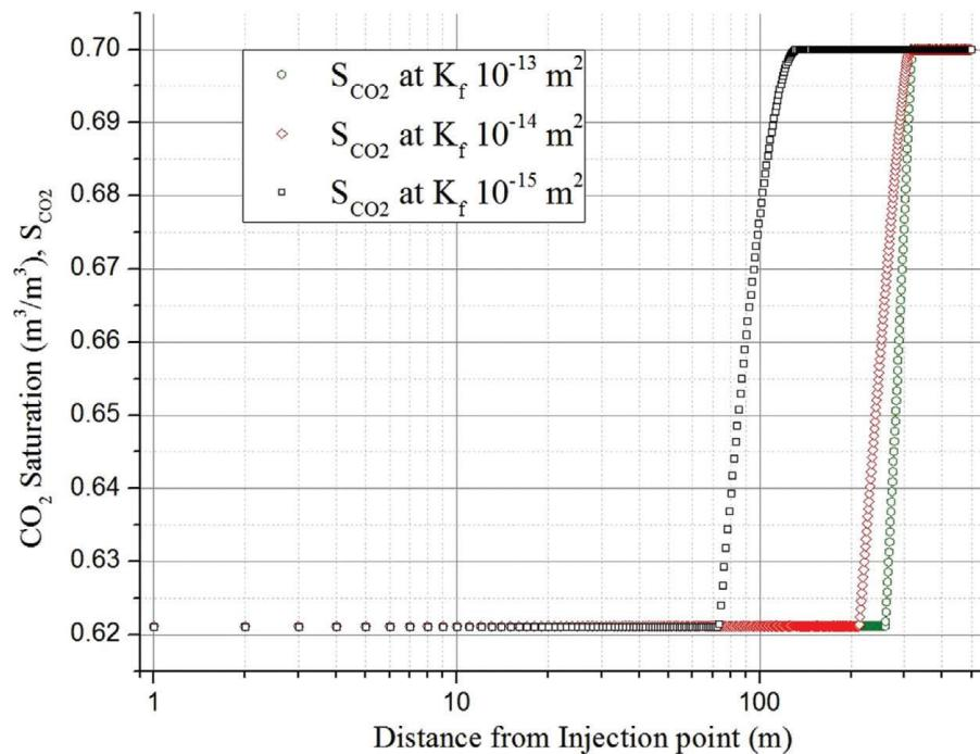
Slika 3-3. Dijagram zasićenja slobodnim CO<sub>2</sub> u ovisnosti o propusnosti i udaljenosti od mesta utiskivanja (Sheraz Ahmad, Yimming Li, 2019.).
