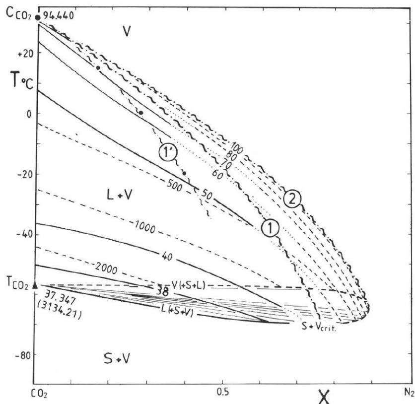
Slika 4-5. TX fazni dijagram binarnog sustava  $\text{CO}_2\text{-N}_2$  (Daramont, 1986.)
