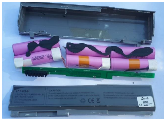
Slika 10-10 Dijelovi baterije prijenosnog računala
