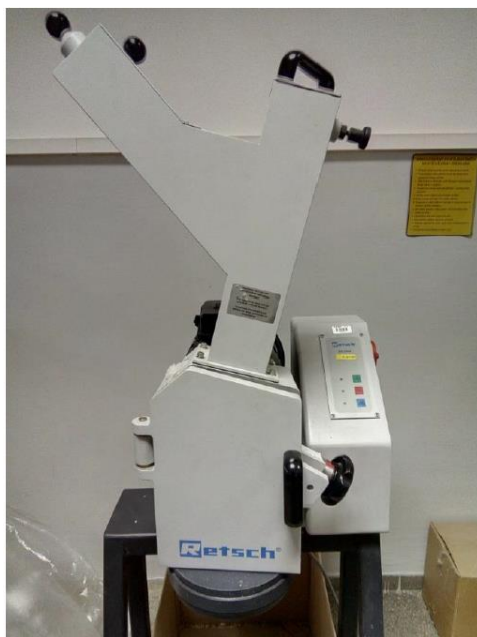
Slika 10-2 Rezni mlin „Cutting Mill RETSCH SM 2000“
