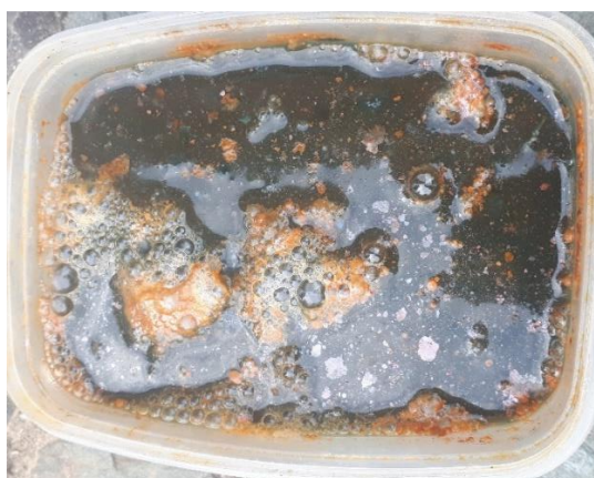
Slika 10-12 Pražnjenje Li-ion baterija u vodenoj otopini NaCl-a (nakon 24 sata)
