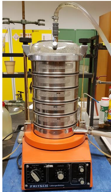
Slika 10-3 Laboratorijski vibracijski uređaj za sijanje „FRITSCH Analysette 3“
