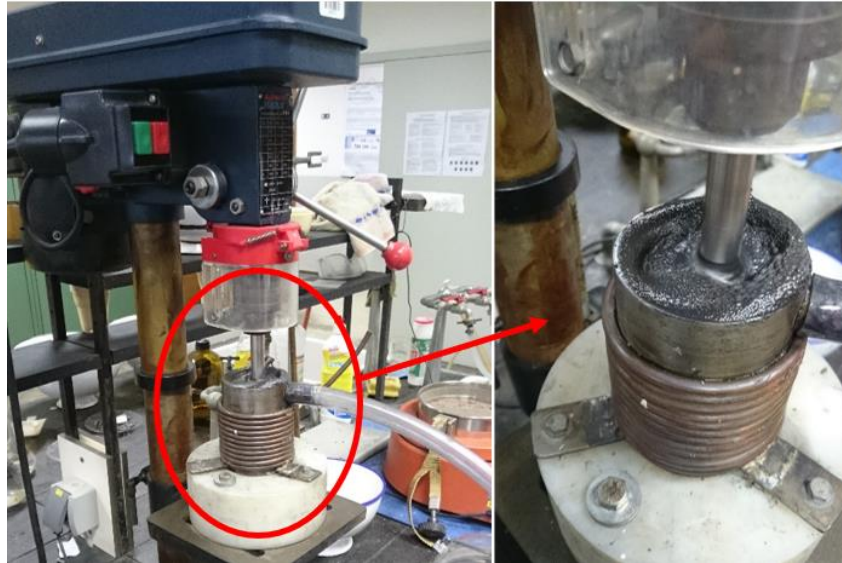
Slika 10-17 Podizanje razine vode i pojava pjene u pokusima s brzinom vrtnje impelera od 1350 \text{ min}^{-1}
