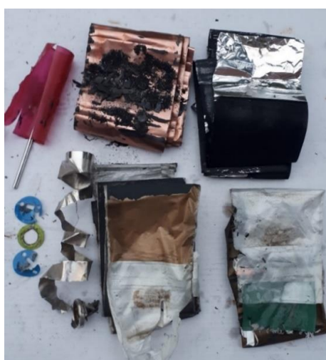
Slika 10-14 Dijelovi Li-ion baterije (razmotani svitak)
