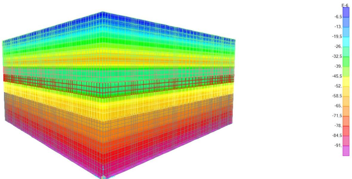
**Slika 4-10** Relativne vertikalne deformacije za model punog bloka
