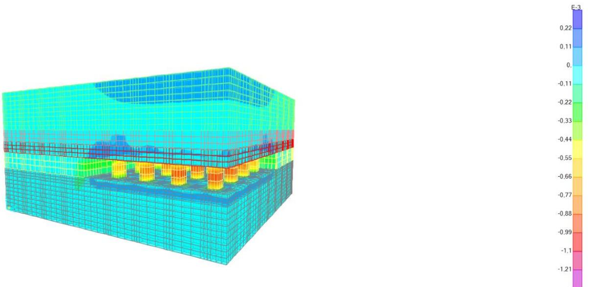
**Slika 4-19** Relativne vertikalne deformacije za model nakon iskopa
