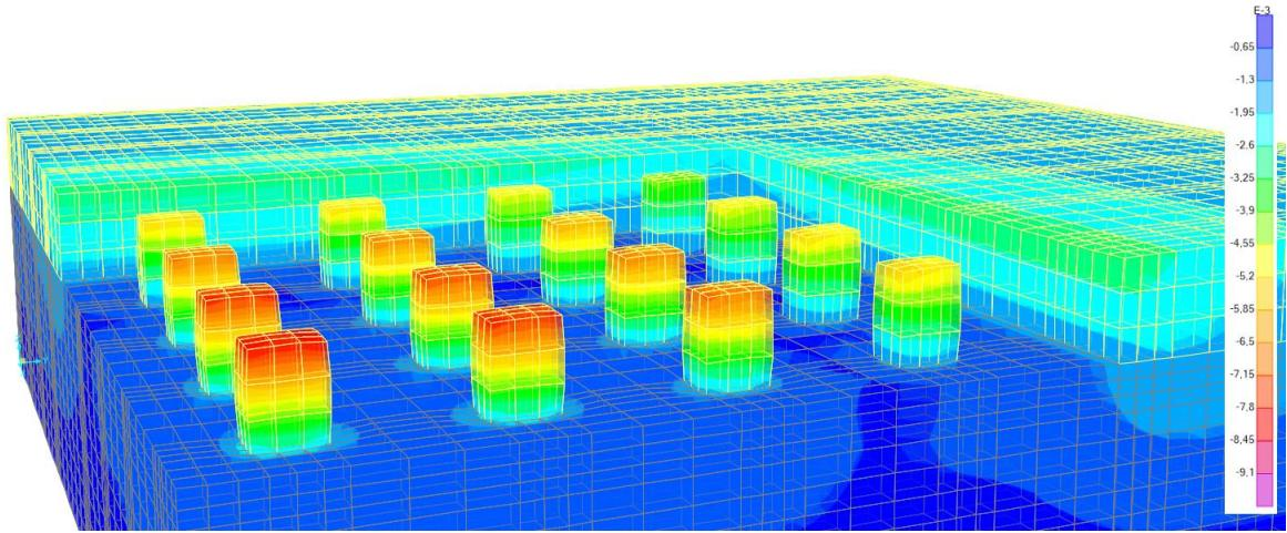
**Slika 4-25** Prikaz deformirane mreže stupova i podine u eksploracijskom sloju s prikazanim pomacima po z osi
