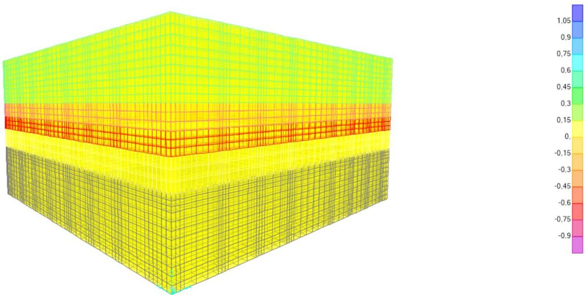
**Slika 4-11** Relativne horizontalne deformacije za model punog bloka
