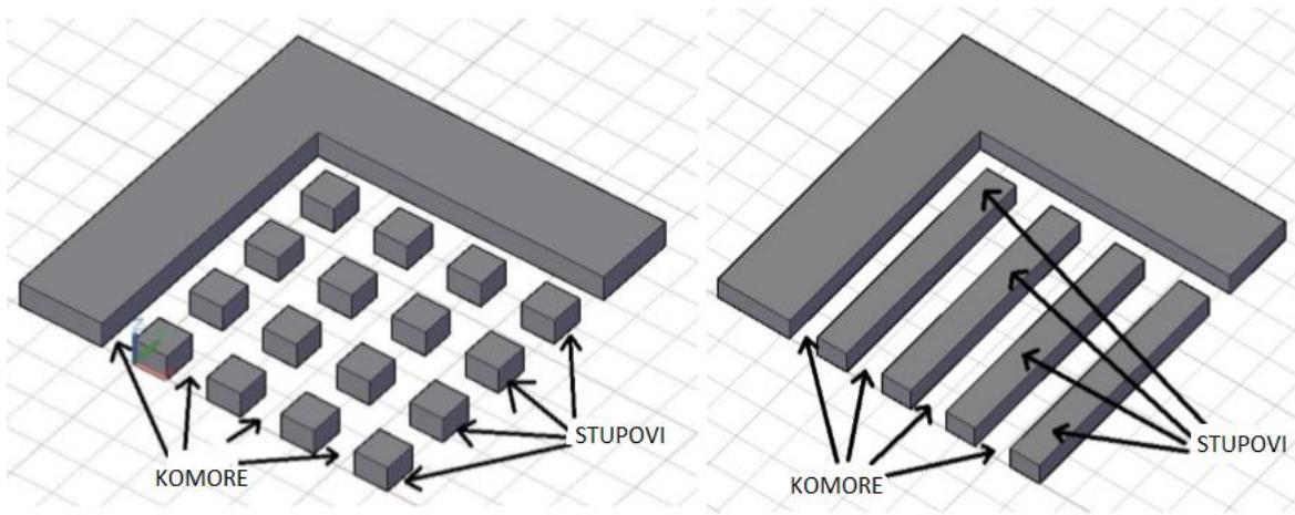
**Slika 3-1** Princip otkopavanja podzemnih prostorija primjenom komorno-stupne metode
