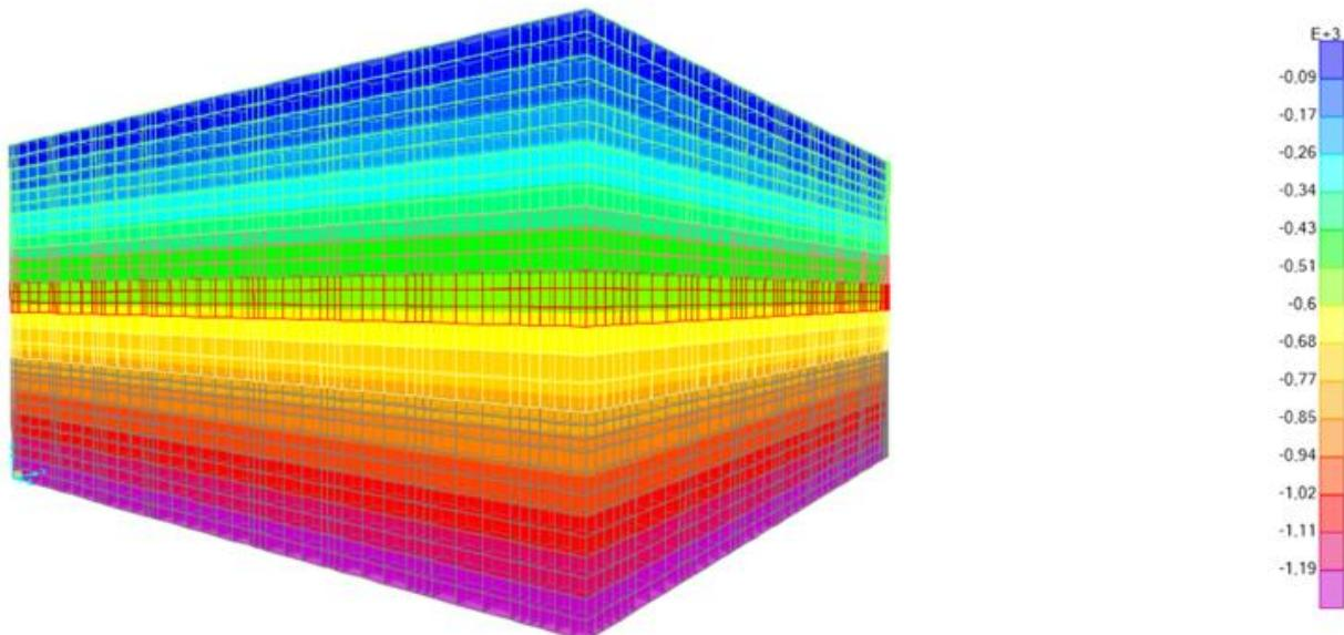
**Slika 4-8** Primarna vertikalna naprezanja za model punog bloka
