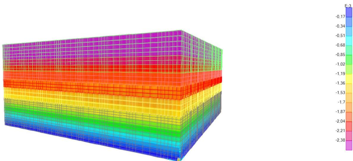
**Slika 4-12** Relativni vertikalni pomaci za model punog bloka
