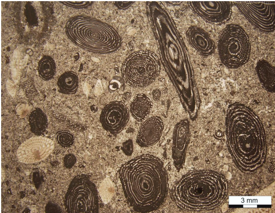
Slika 5.33. Mikrofacijes alveolinskoga vekston/pekstona. Na slici su osim alveolina vidljivi i numuliti, miliolide te drugi plitkovodni paleogenski bentos. Uzorak iz paleogenskih ljustaka jugozapadnoga dijela istraživanog područja.
