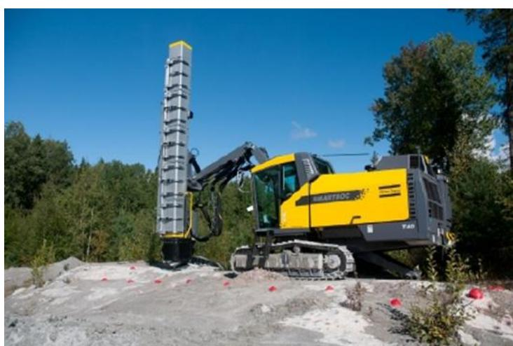
Slika 3-6. Zvučna izolacija vanjskog bušačeg čekića (Atlas Copco, 2010.)
