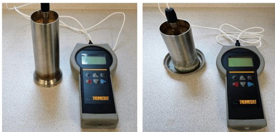
Slika 7-2 TLS-100- uređaj kojim ispituje tlo metodom tranzijentnog protoka topline (Termtest INC., 2019.)
