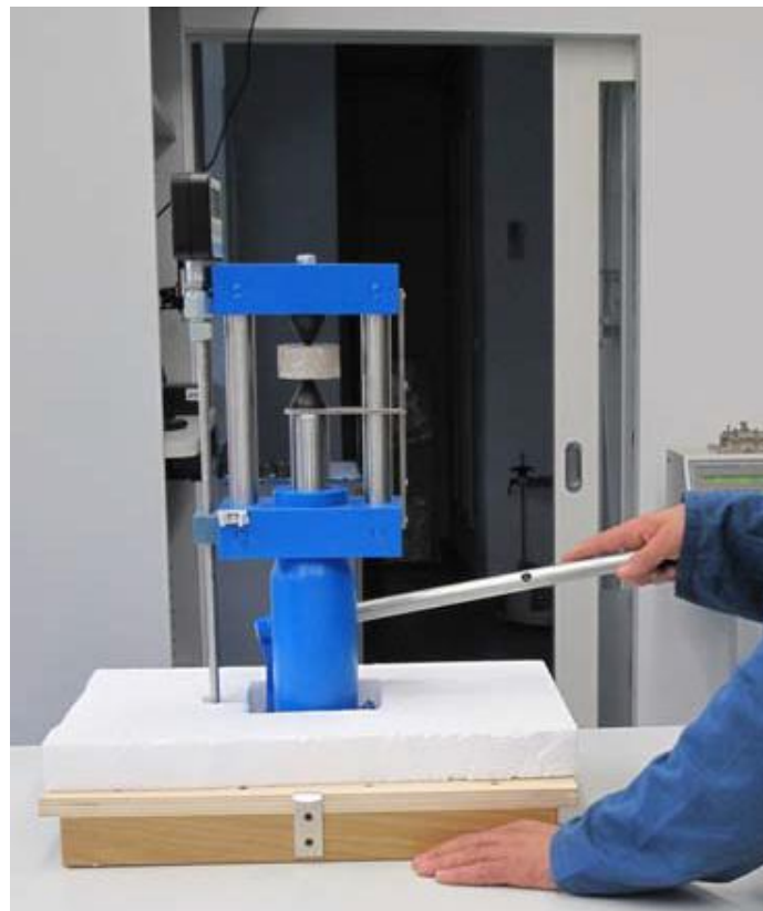
Slika 4-12 Uređaji za ispitivanje opterećenjem u točki (Briševac, 2012)
