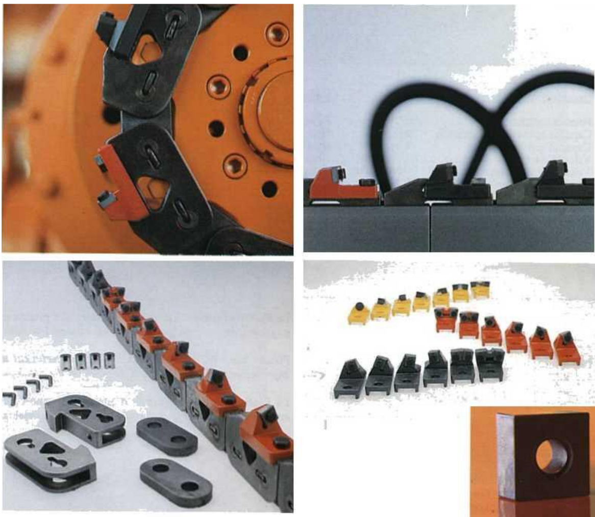
Slika 2-3 Lanac, segment lanca, rezne pločice i zubi (Dunda, Kujundžić, 2003).
