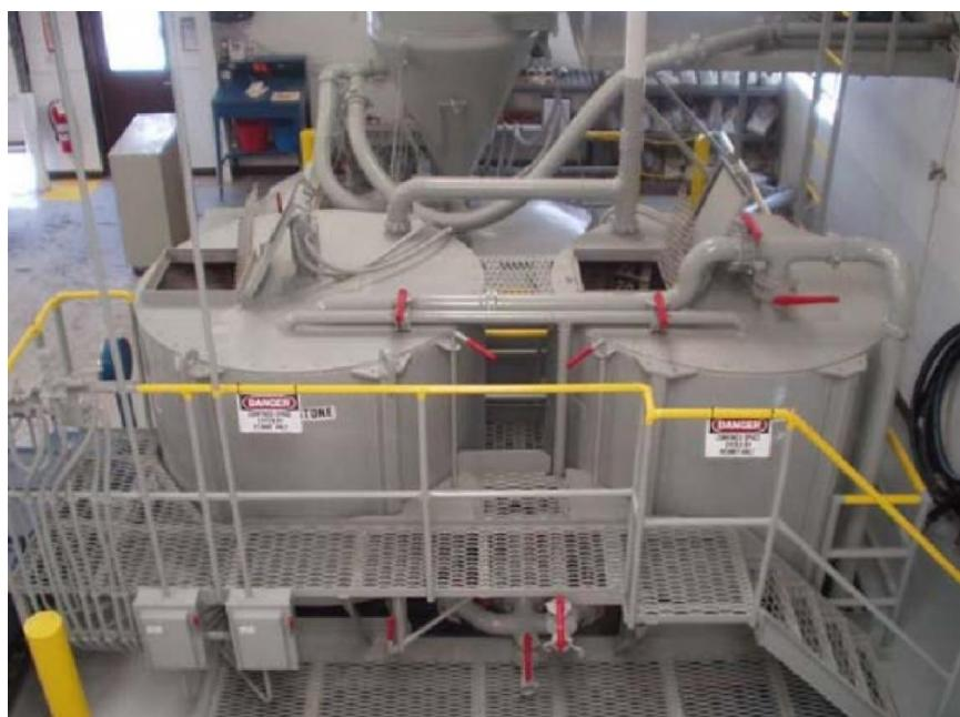
Slika 6-1. Postrojenje za pripremu cementne kaše izvan lokacije bušotine (Merritt, 2005)
