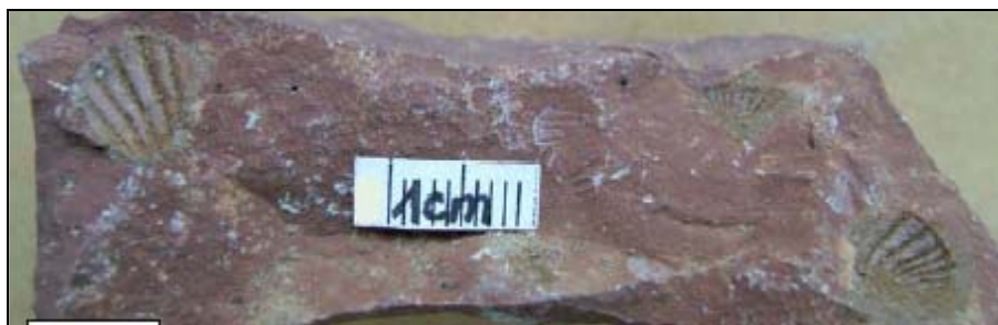
Slika 3.23: Uzorak proslojka pjeskovitog fosilifernog lapora u ležištu R iz bušotine Klo-1 (911,9 – 917,9 m, 1 m) s makrofosilima (autor TADEJ, J., iz studije: VELIĆ et al., 2008*)
