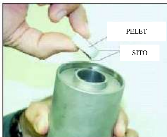
Slika 3-9. Umetanje peleta i sita u ispitnu ćeliju
