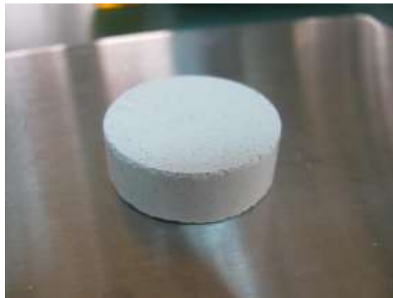
Slika 3-1. Izgled peleta nakon komprimiranja
