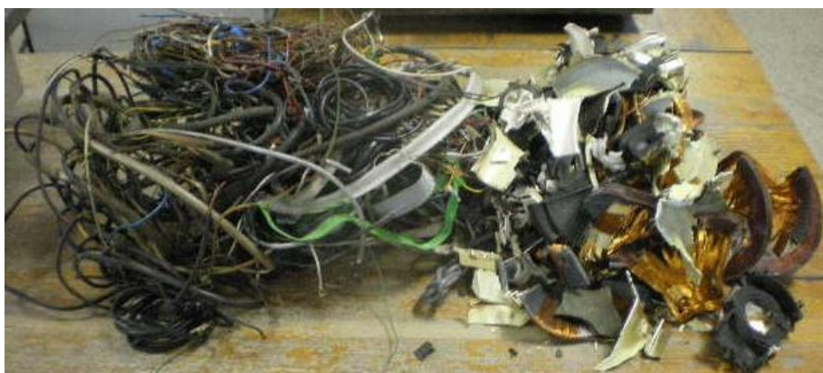
Slika 4 – 78 Otklonski svitci, kabeli, konektori i žice
