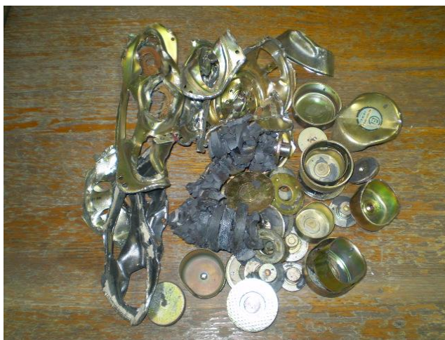
Slika 4 – 28 Ručno izdvojeno željezo nakon primarno sitnjenja u udarnoj drobilici
