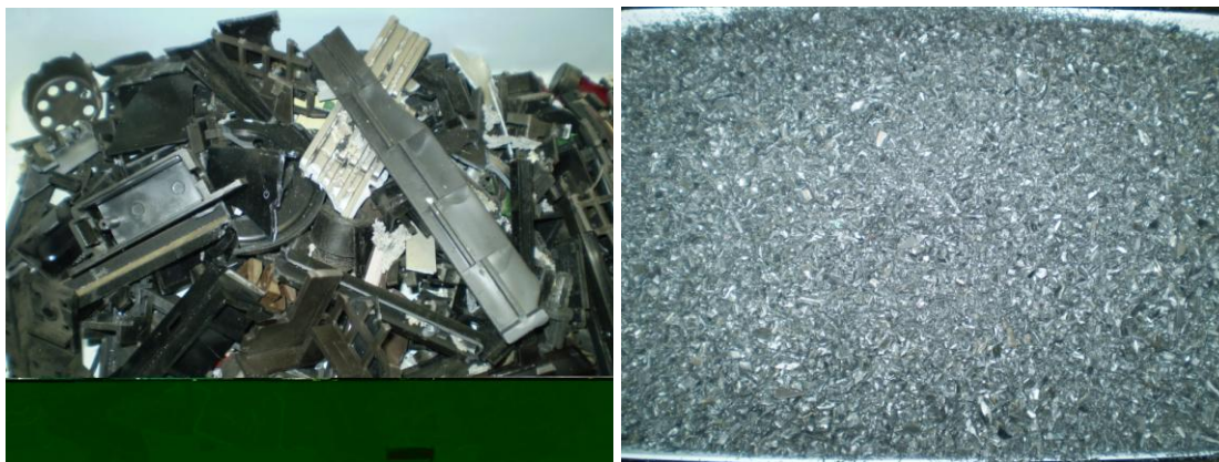
Slika 4 – 240 Plastično kućište; a) dijelovi i b) drobljena plastika
