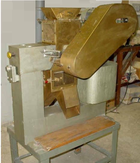
Slika 4 – 17 Laboratorijski suhi visokointenzivni magnetski separator ("Humboldt-Wedag")
