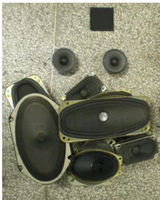
Slika 4 – 26 Zvučnici nakon odvajanja audio sustava
