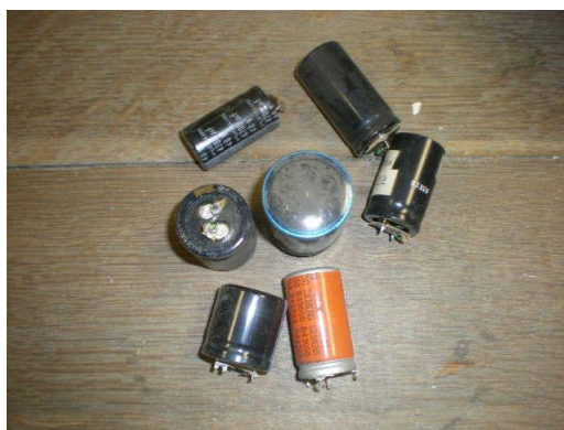
Slika 4 – 241 Elektrolitski kondenzatori \varnothing + 25 mm i visine + 25 mm
