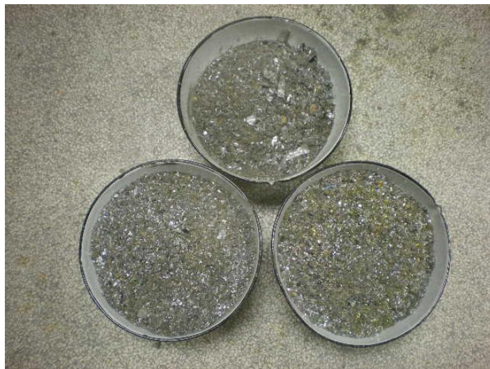
Slika 4 - 185 Tiskane pločice nakon sekundarnog sitnjenja
