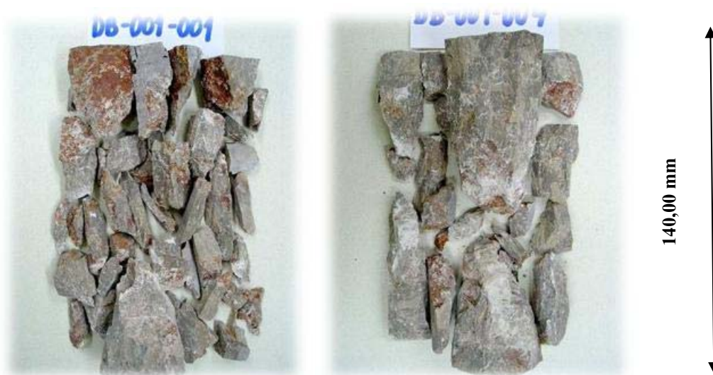
Slika 7.4. Uzorci oznake DB-001-001 i DB-001-004. nakon ispitivanja fizičko-mehaničkih svojstava
