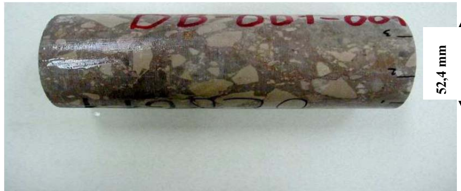
Slika 7.3. Uzorak oznake DB-001-001 pripremljen za ispitivanja fizičko-mehaničkih svojstava
