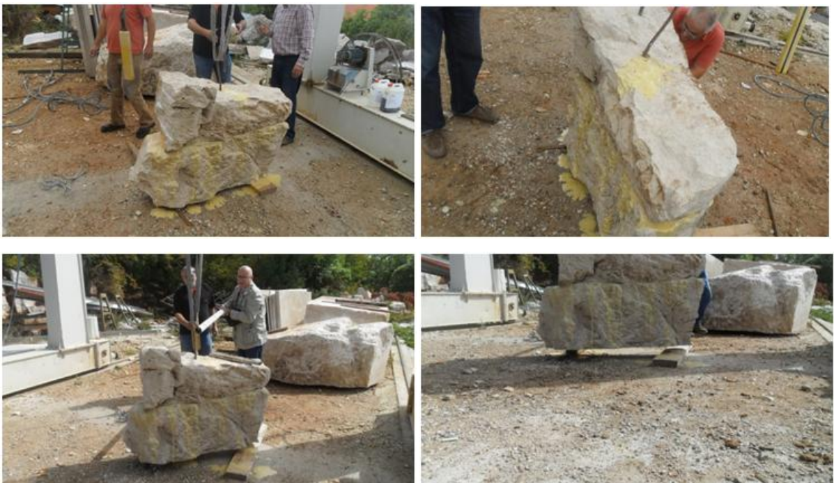
Slika 8.7. In situ ispitivanje vlačne čvrstoće zalijepljenog spoja
