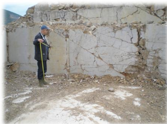
Slika 7.14. Snimanje pukotina istočnog čela za izračun potrebnih količina
