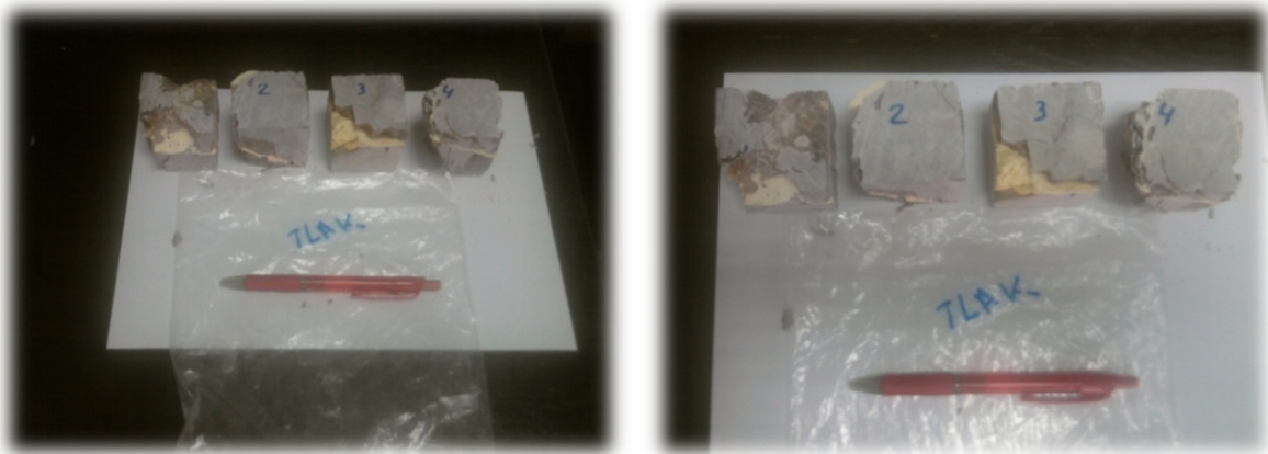
Slika 7.41. Zalijepljeni uzorci nakon ispitivanja čvrstoće na tlak u suhom stanju
