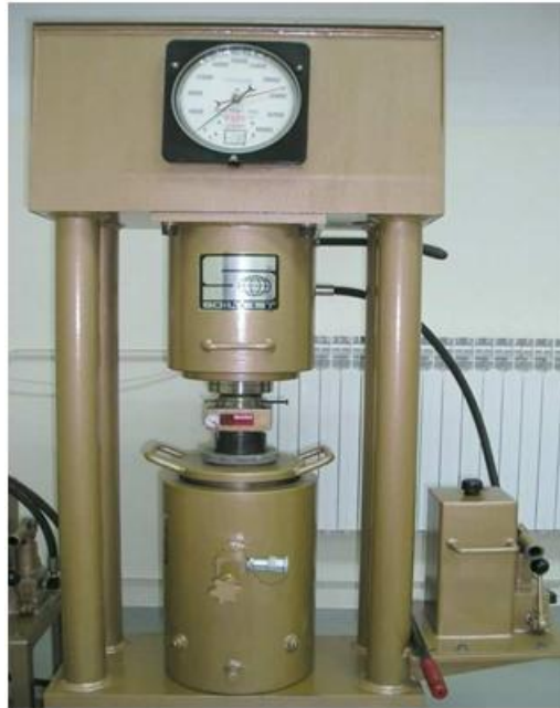
Slika 6.9. Preša SOILTEST CT-732
