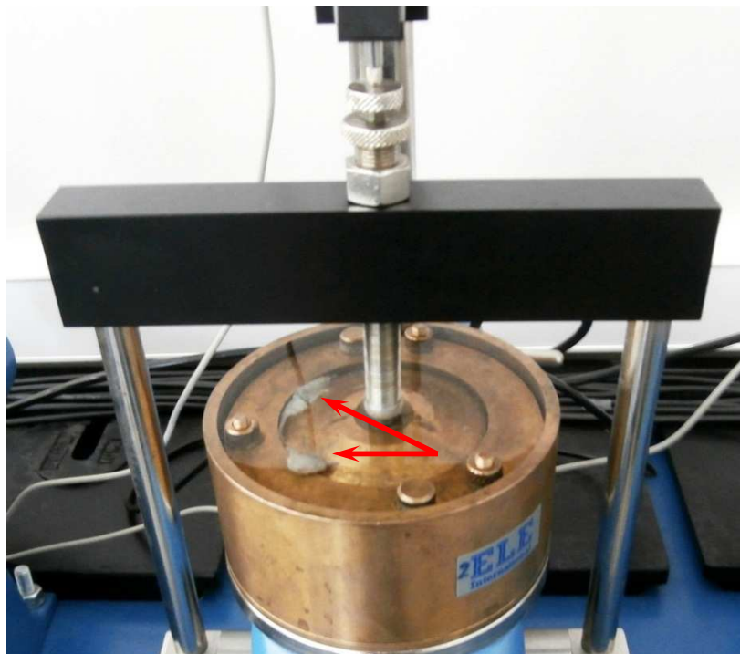
Slika 5-12 Istiskivanje uzorka iz edometarske ćelije
