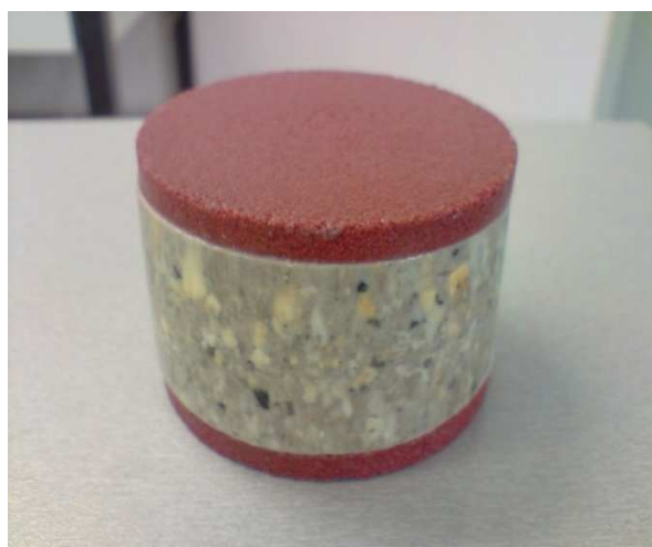
Slika 4-2 Uzorak pripremljen za ugradnju u troosnu ćeliju
