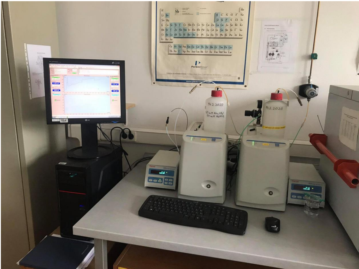
Slika 3.4. Ionski kromatograf u laboratoriju za analizu geoloških materijala (LaGEMA) Rudarsko-geološko-naftnog fakulteta
