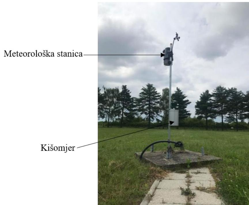
Slika 3.2. Meteorološka stanica i kišomjer
