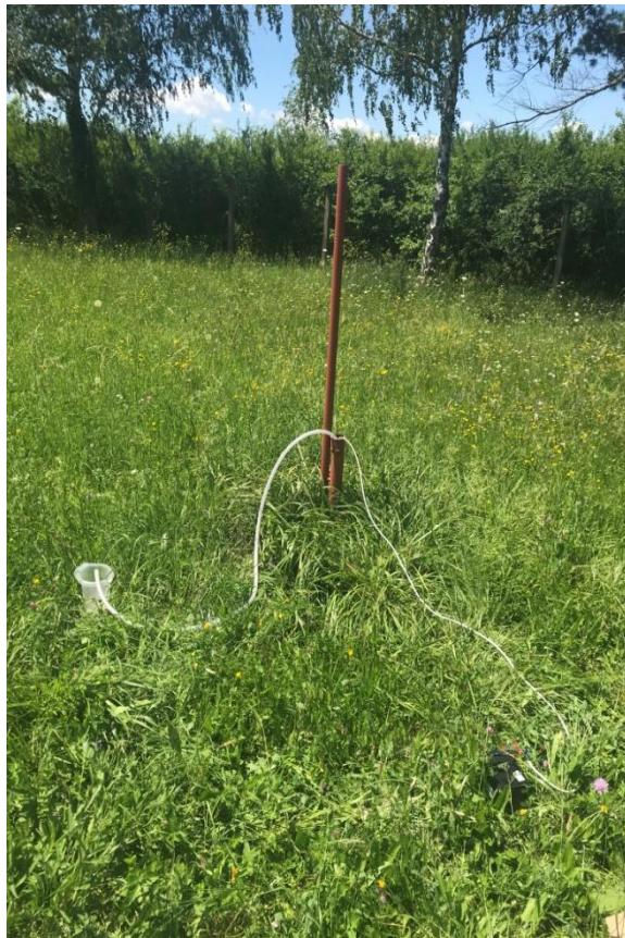
Slika 3.3. Uzimanje uzorka podzemne vode iz piezometra P-61
