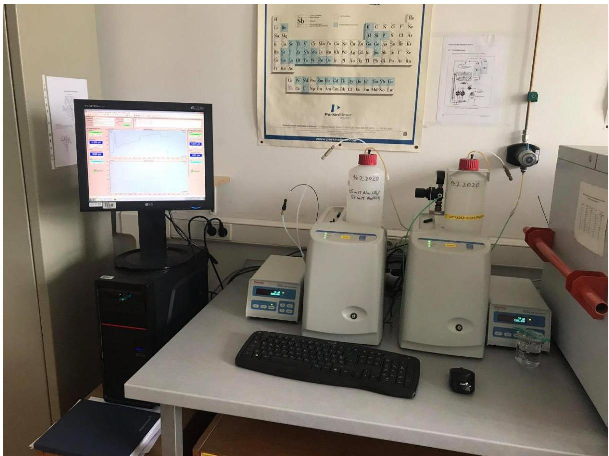
Slika 3.4. Ionski kromatograf u laboratoriju za analizu geoloških materijala
