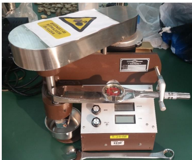
Slika 5-6. Uređaj za određivanje mazivosti isplaka kompanije OFITE
