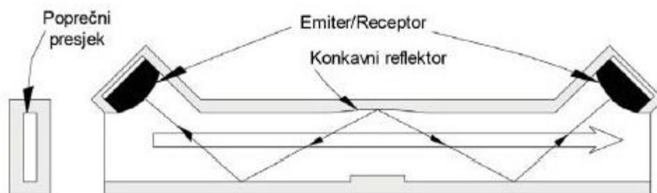
**Slika 2-8.** Shema ultrazvučnog mjerila protoka (Pavlović et al., 2020.)
