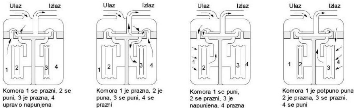
**Slika 2-2.** Princip rada membranskog plinskog brojila (Pavlović et al., 2020.)
