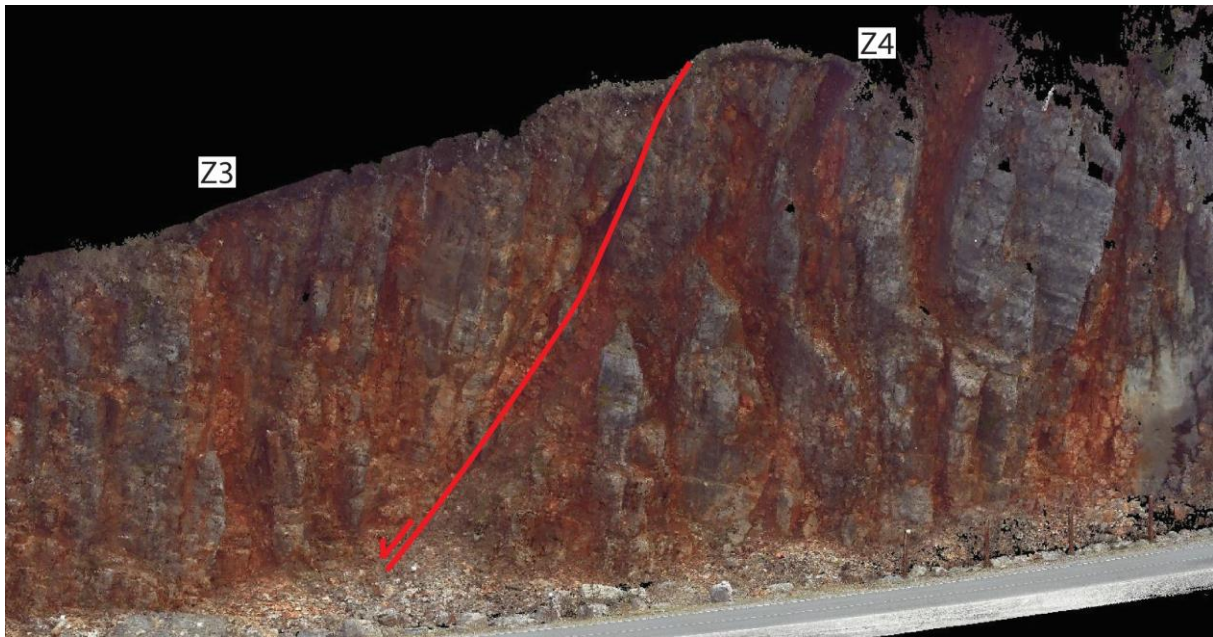
Slika 4.41. Podjela dijela stijenskog zasljeva na lokaciji Špičunak na dvije zone gdje granicu između zona predstavlja normalni rasjed pri čemu je vidljiva razlika u stupnju trošnosti stijenske mase i u geometrijskim značajkama diskontinuiteta u svakoj pojedinoj zoni.
