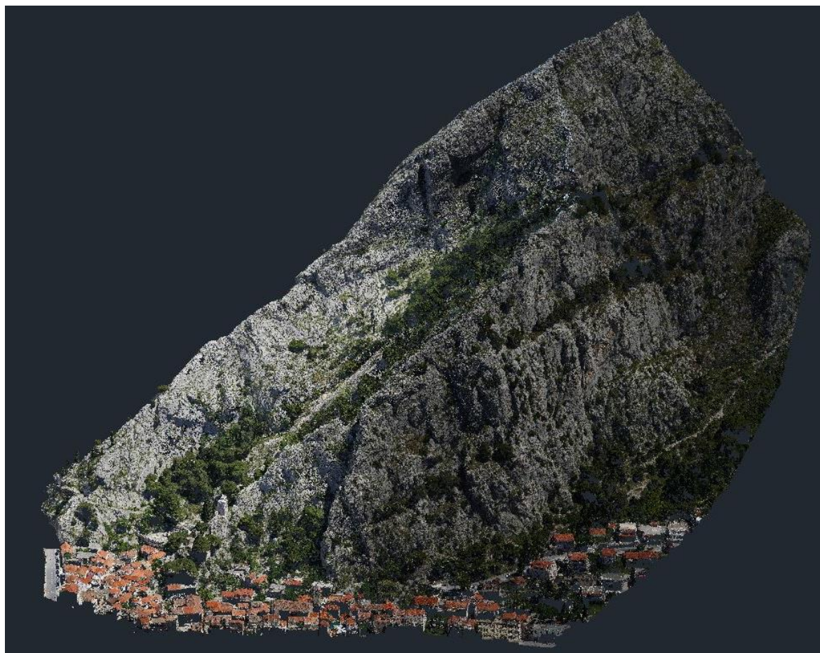
Slika 4.2. Izrađeni model oblaka točaka istraživanih stijenskih kosina Omiške Dinare vizualiziran u AutoCAD -u.
