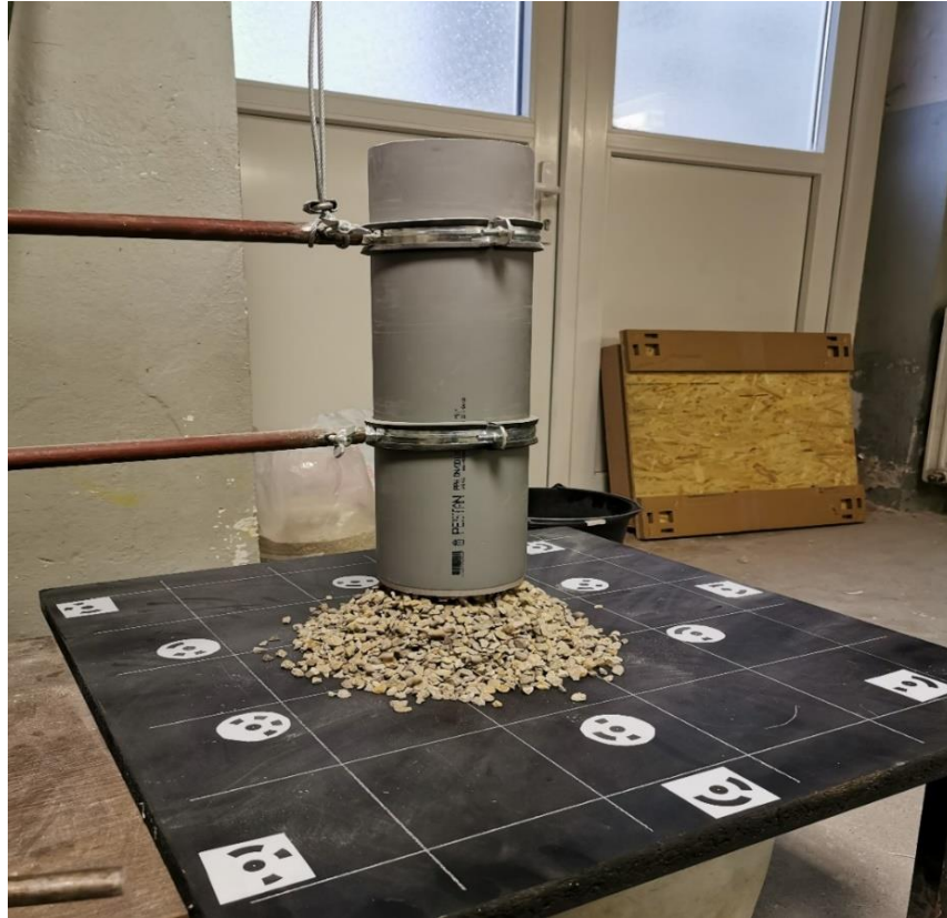
Slika 3.10 Slika mjerenja podiznim cilindrom
