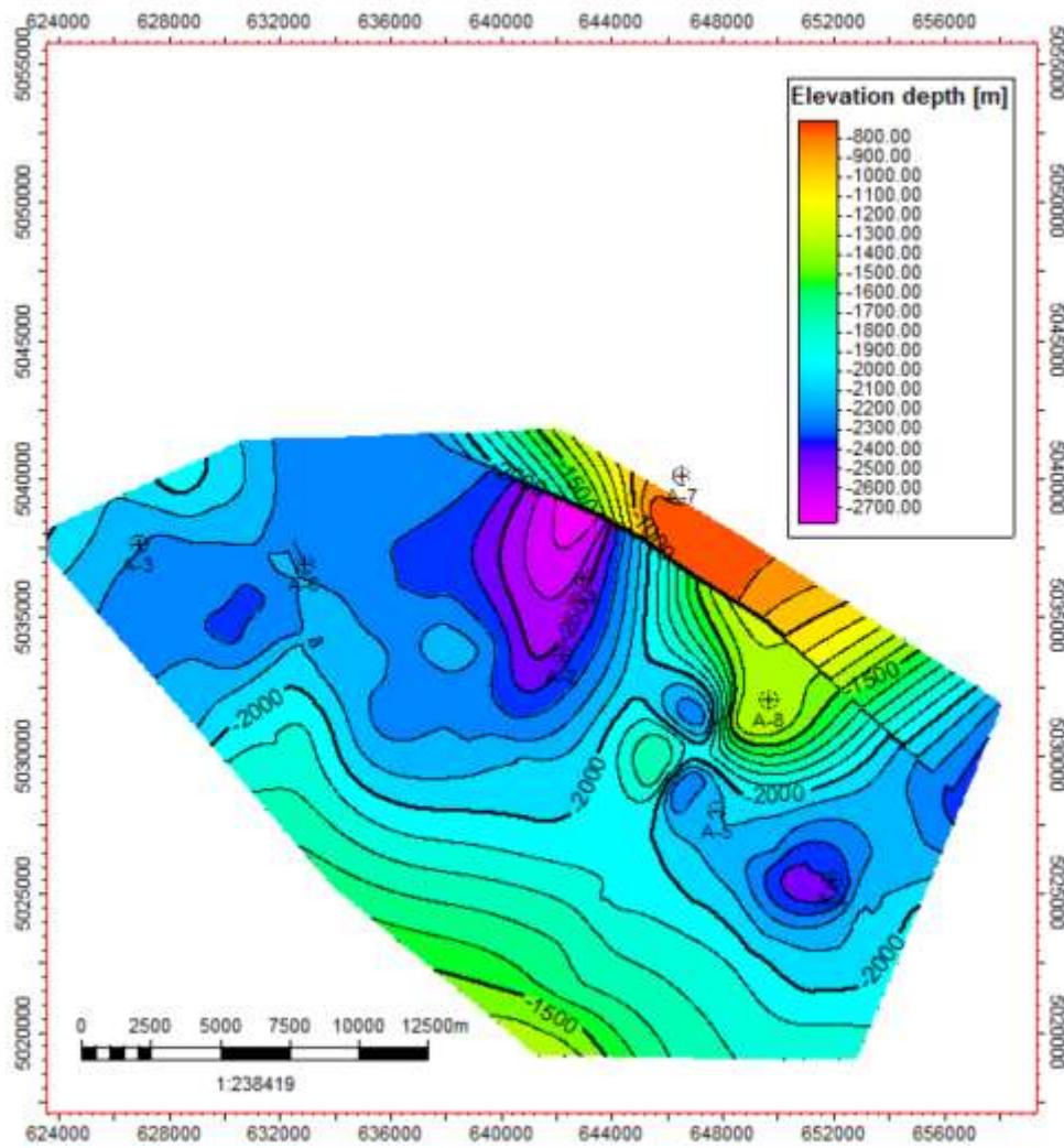
Slika 10 Strukturna karta po elektrokarotažnom markeru Rs5
