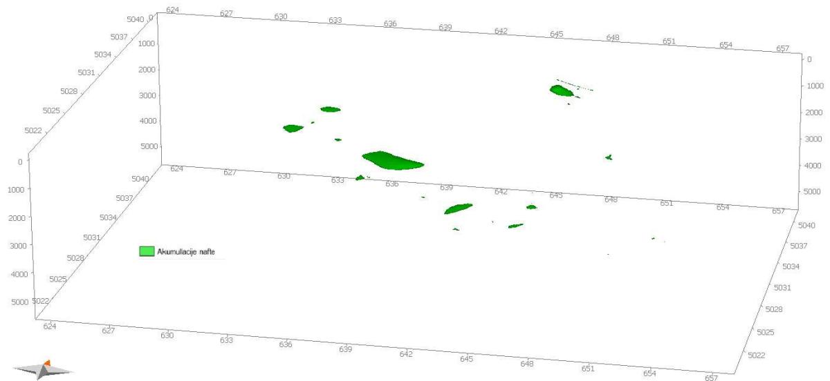
Slika 15 3D prikaz ležišta ugljikovodika nakon dovršene simulacije modela
