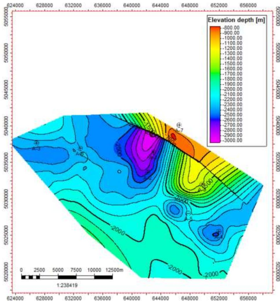
Slika 9 Strukturna karta po elektrokarotažnom markeru *Rs7*
