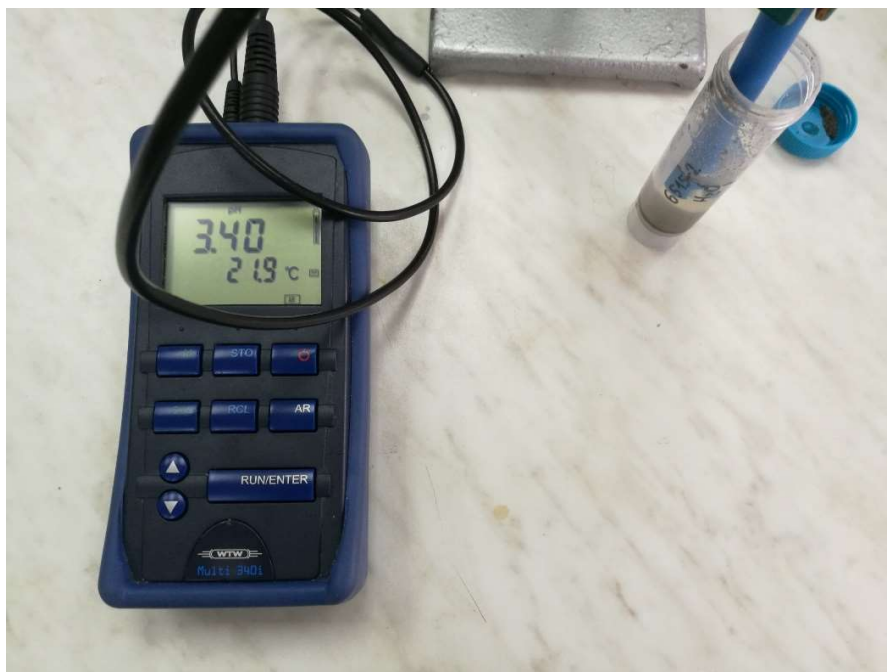
Slika 5. Mjerenje pH uređajem WTW Multi 340i
