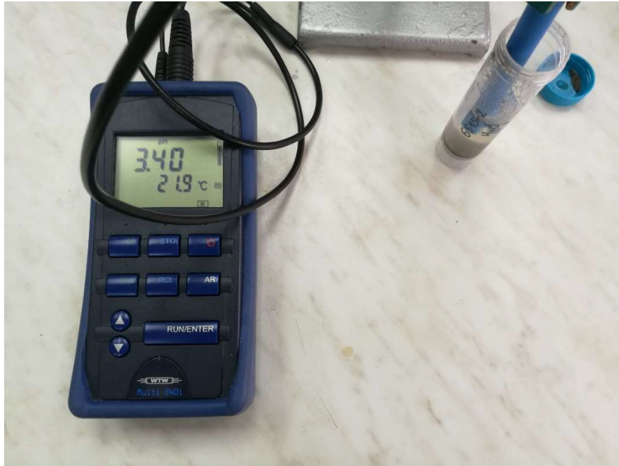
Slika 5. Mjerenje pH uređajem WTW Multi 340i
