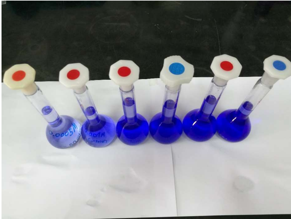
Slika 10. Priprema standardnih otopina Cu-kompleksa
