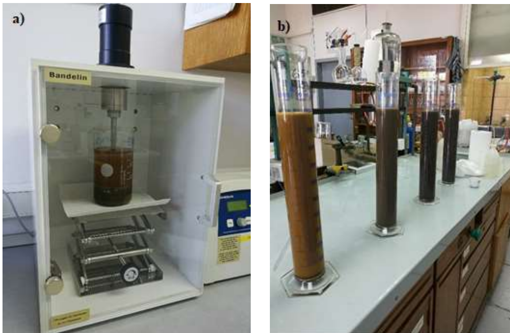
Slika 8. a) ultrazvučni štap; b) sedimentacija čestica u menzurama
