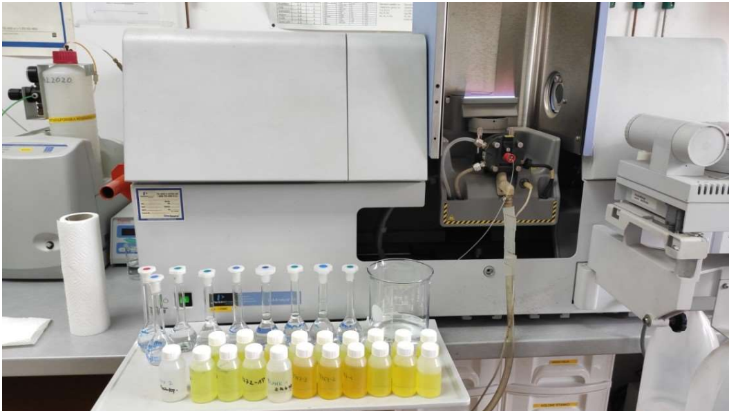
Slika 12. Mjerenje elemenata plamenom tehnikom na atomskom spektrometru Perkins Elmer AAnalyst 700 (foto: Adelita Skitarelić)
