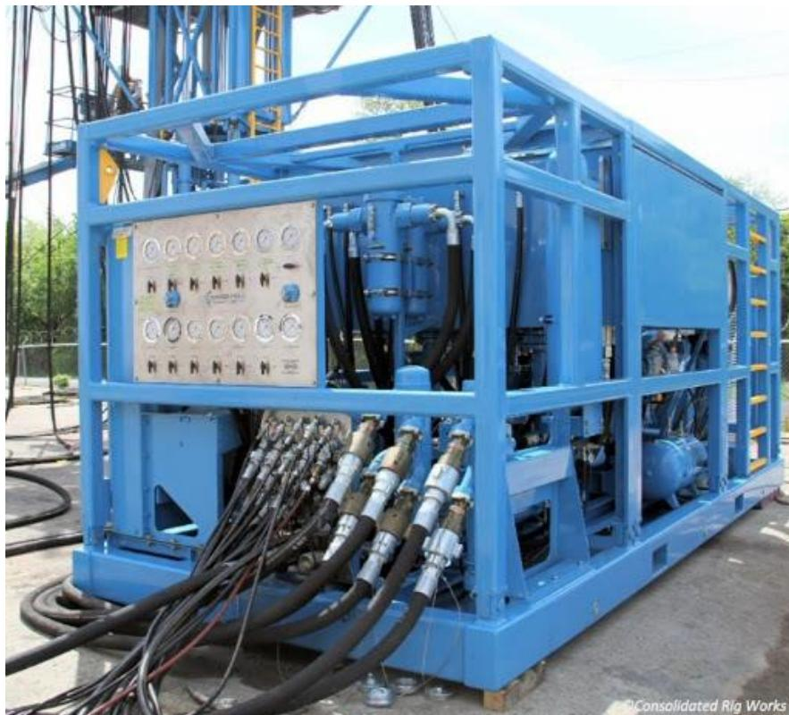
Slika 3-3. Pogonsko-hidraulički sustav savitljivog tubinga (Consolidate rig works, 2020)
