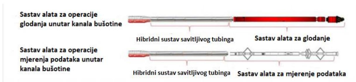
**Slika 5-4.** Otvorena konstrukcija dubinskih alatki hibridne tehnologije saviljivog tubinga (Higuera et al., 2020)
