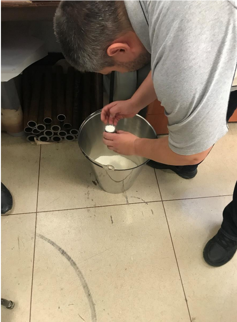
Slika 4-22. Punjenje uzorka ANFO eksplozivom
