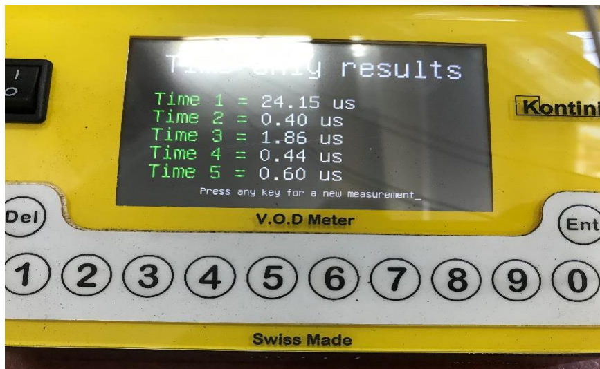
Slika 4-25. Prikaz rezultata na uređaju Explomet
