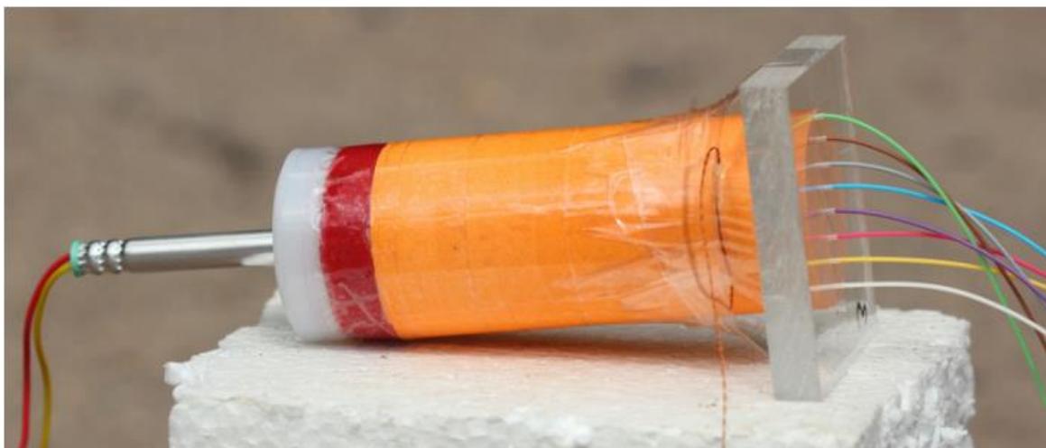
Slika 3-15. Raspored osjetila po promjeru eksploziva (Pachman, 2019)
