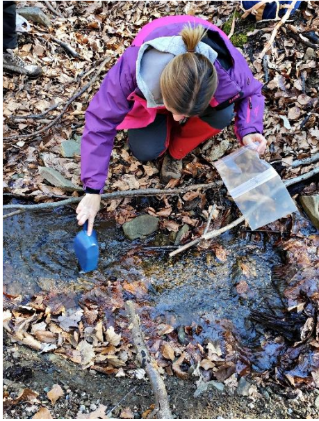
Slika 9.4. Uzorkovanje vodotočnog sedimenta potoka Čatrnja (foto: Adelita Skitarelić)
