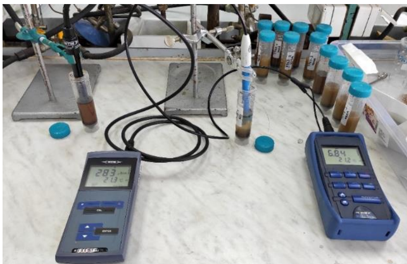
Slika 9.9. Mjerenje pH vrijednosti (lijevo) i električne vodljivosti (desno) vodotočnog sedimenta (foto: Adelita Skitarelić)
