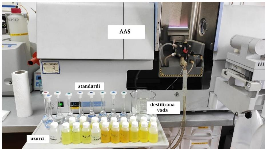
Slika 9.13. Analiza uzorka atomskom apsorpcijskom spektrometrijom (foto: Adelita Skitarelić)
