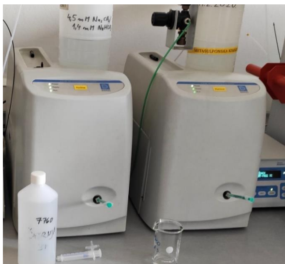
Slika 9.18. Injektiranje uzoraka vode u uređaj (foto: Adelita Skitarelić)
