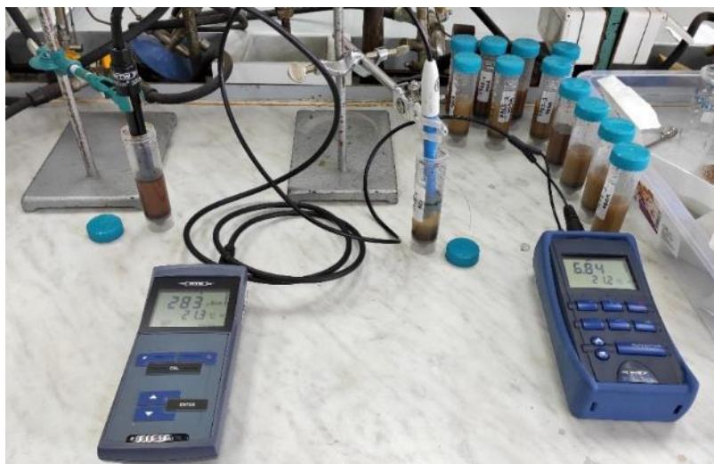
*Slika 9.9. Mjerenje pH vrijednosti (lijevo) i električne vodljivosti (desno) vodotočnog sedimenta
