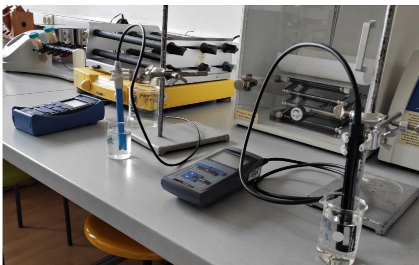
Slika 9.17. Mjerenje pH i EC uzoraka vode (foto: Adelita Skitarelić)
