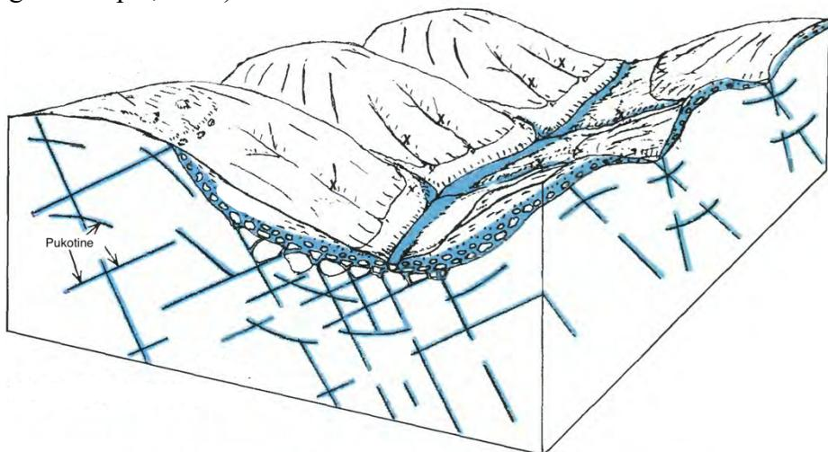
Slika 2.1. Shematski prikaz pukotinskog vodonosnika (prema Heath, 1984)
