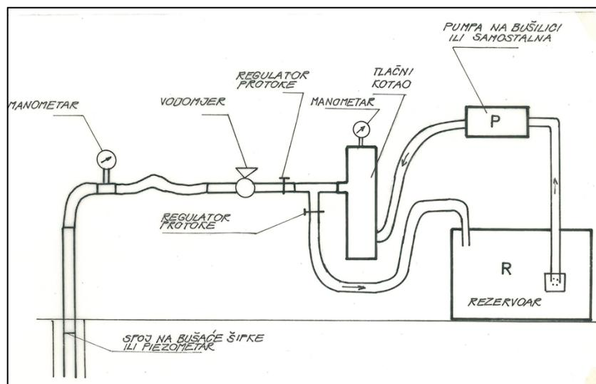
Slika 6.1. Prikaz korištenog sustava za održavanje konstantnog tlaka i utiskivanje vode
