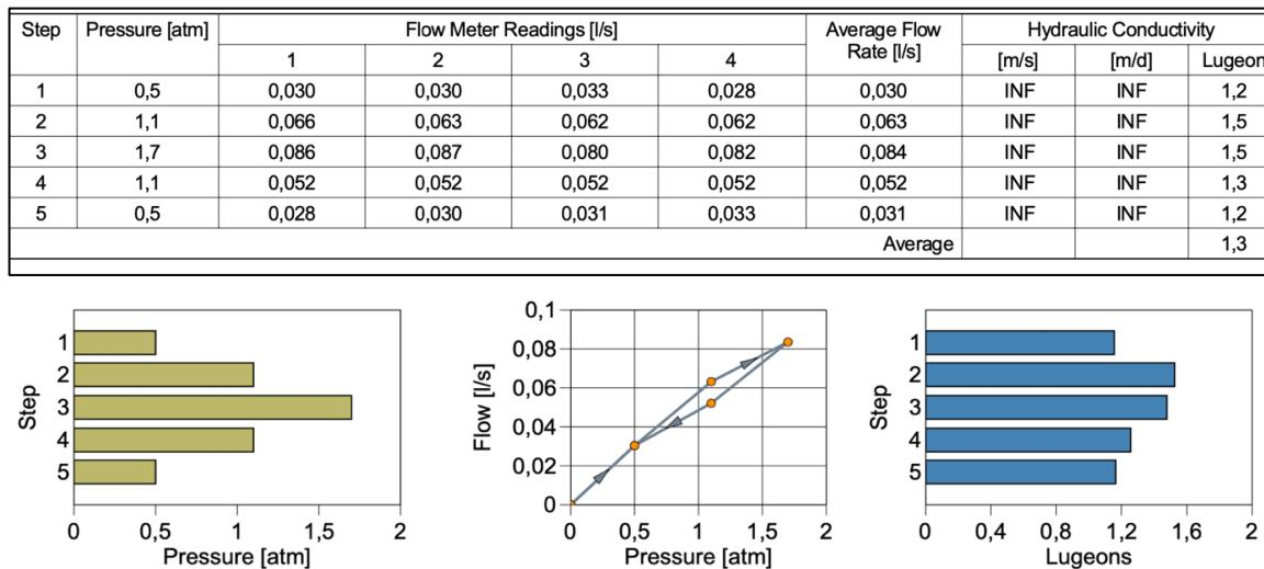
Slika 6.11. Dijagrami tlak-korak, tlak-protok i Lugeonova jedinica-korak za test broj 47
