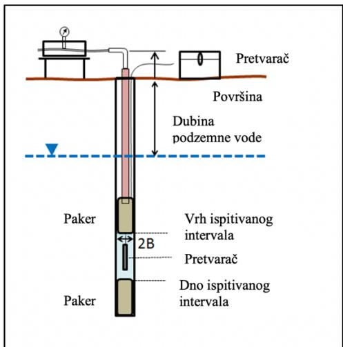
Slika 4.2. Mjerenje tlaka bušotinskim pretvaračem (Waterloo Hydrogeologic, 2020)
